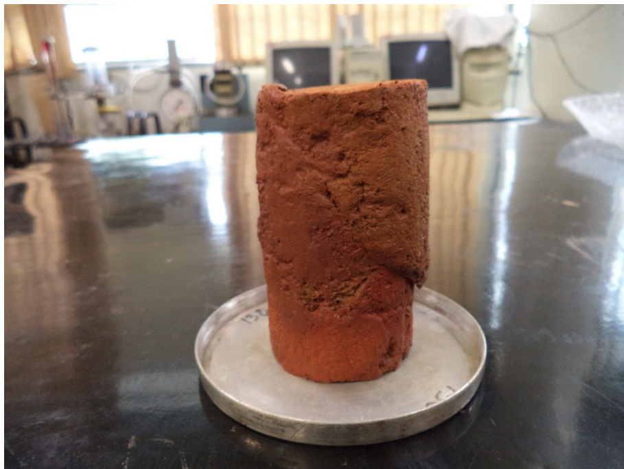
Figura 4.11 – Foto após o ensaio com plano de ruptura formado sobre a banda mais rija
