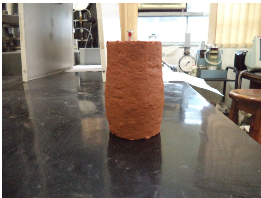
Figura 4.16 - Abaulamento do corpo de prova após a ruptura
