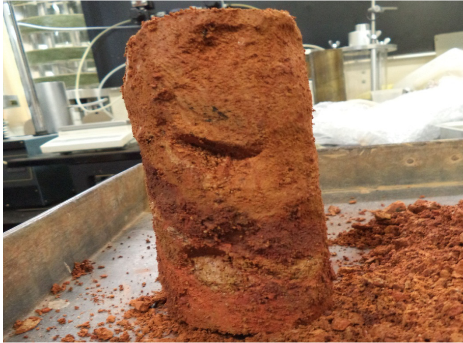
Figura 4.10 - Corpo de prova sendo entalhado e apresentando banda mais resistente (inclinada para a direita)
