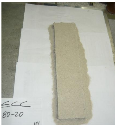
Figura 4.18: Execução do ensaio de Altura de Mancha de Areia nas vigas das misturas alternativas. Fonte: foto do autor.
