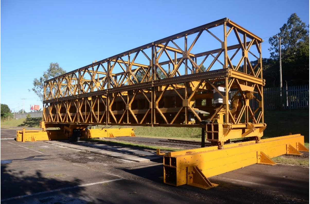
Figura 3.28: Simulador de tráfego do LAPAV. Fonte: foto do autor.
