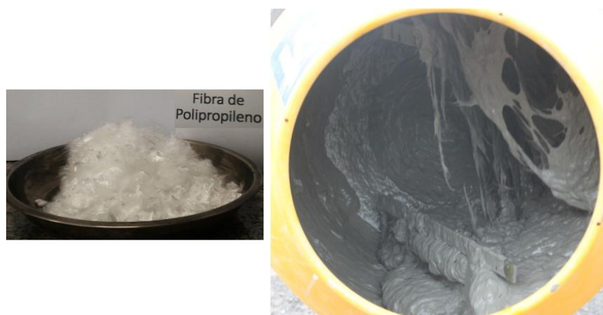
Figura 3.14: Processo de mistura, adição da fibra. Fonte: fotos do autor.
