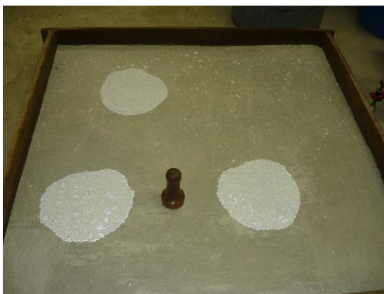
Figura 4.8: Distribuição dos ensaios de altura da mancha de areia na placa de ECC. Fonte: foto do autor.
