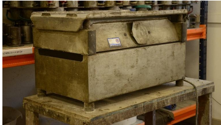
Figura 3.15: Mesa vibratória utilizada na concretagem dos corpos de prova. Fonte: foto do autor.
