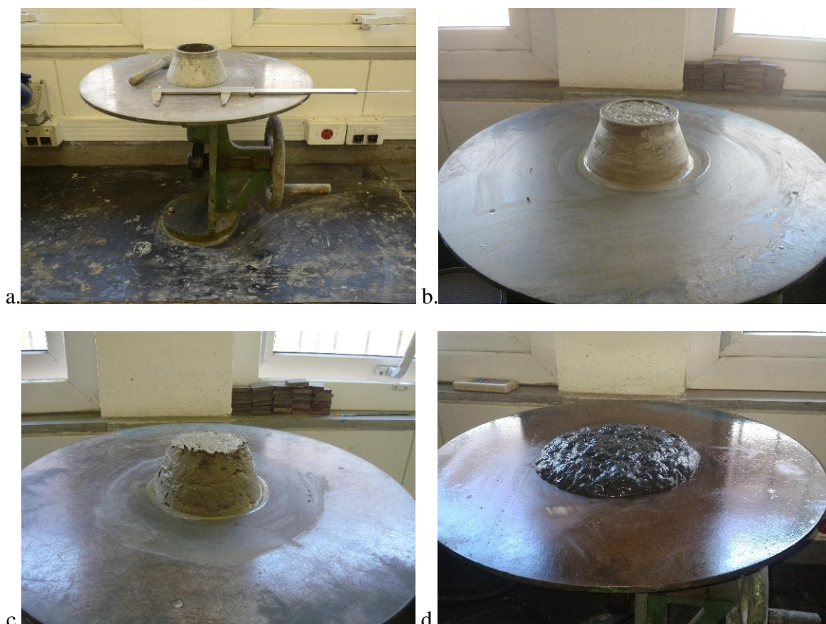
Figura 3.39: Sequência da execução de ensaios de flow table : (a) elementos para o ensaio; (b) cone cheio e nivelado; (c) retirada do cone; (d) final do ensaio. Fonte: fotos do autor.
