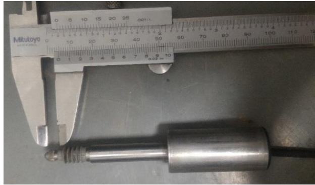
Figura 3.25: LVDT utilizado para medir deflexões nos ensaios dinâmicos. Fonte: foto do autor.
