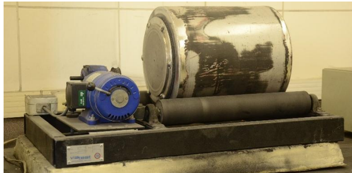
Figura 3.8: Moinho de bolas usado para moer a CCA. Fonte: foto do autor.
