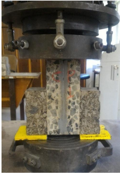
Figura 3.38: Corpo de prova disposto na prensa para o ensaio de cisalhamento direto. Fonte: foto do autor.
