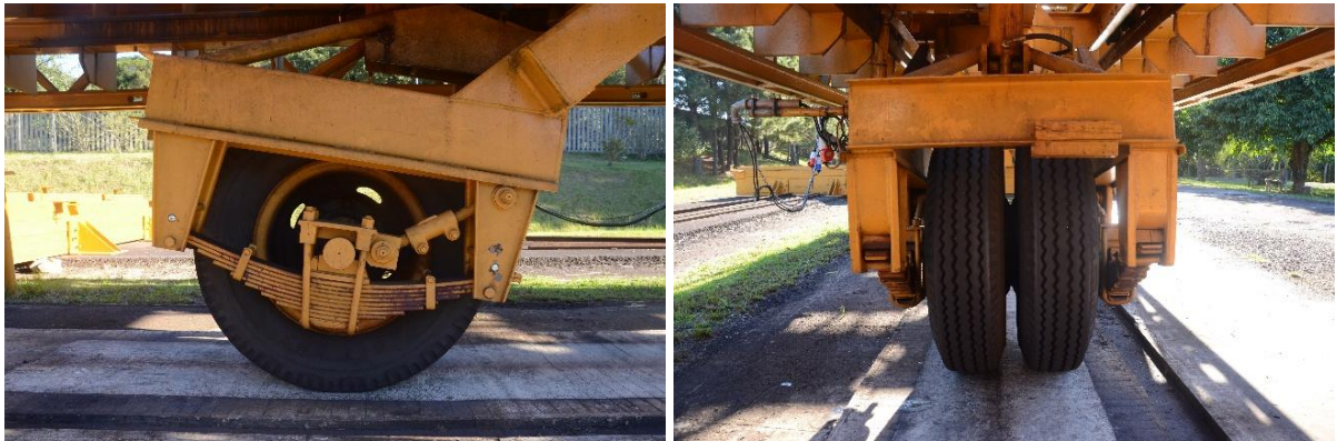
Figura 3.29: Detalhe do trem de carga do simulador linear de tráfego. Fonte: fotos do autor.
