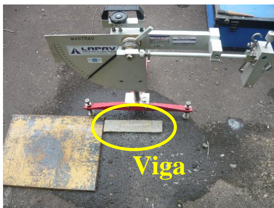
Figura 4.17: Equipamento para a execução do ensaio de Pêndulo Britânico nas vigas das misturas alternativas. Fonte: foto do autor.
