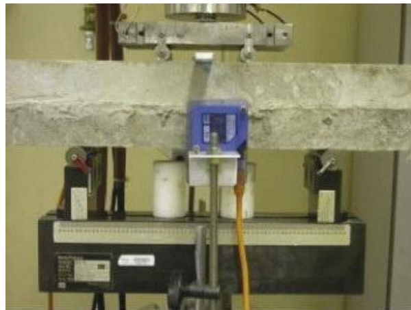
Figura 2.24: Configuração de ensaio a flexão quatro pontos para vigas compostas concreto simples/PVAECC. Fonte: Leung et al. (2007).
