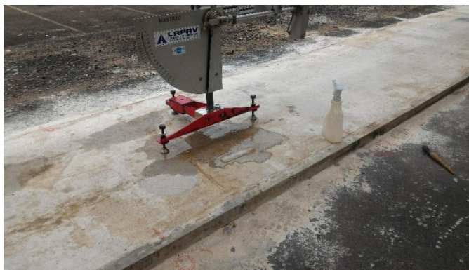
Figura 3.48: Ensaio de Pêndulo Britânico no recapeamento de 50 mm. Fonte: foto do autor.
