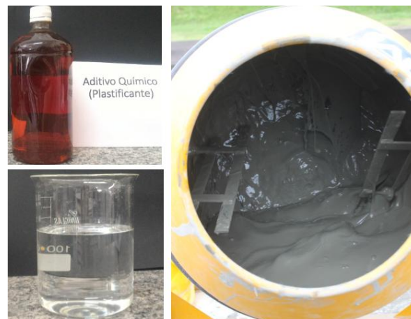
Figura 3.13: Processo de mistura, água e aditivo químico. Fonte: fotos do autor.
