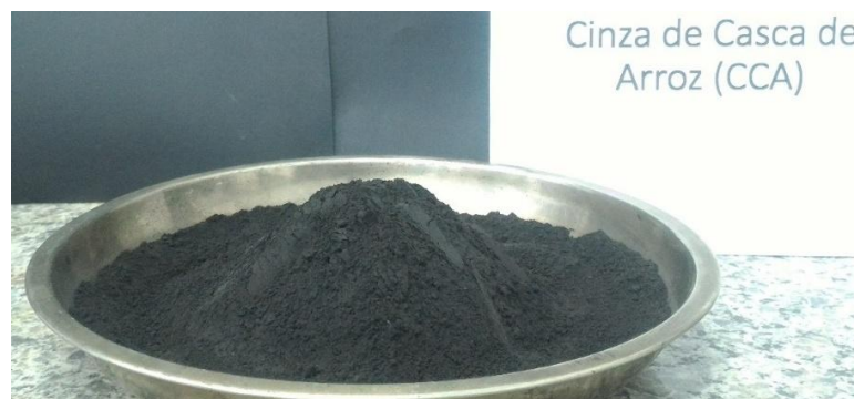
Figura 3.9: Cinza de casca de arroz (CCA) moída por 4 horas, utilizada na pesquisa. Fonte: foto do autor.
