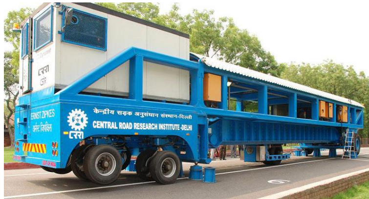
Figura 2.33: Simulador de tráfego móvel, modelo HVS ( Heavy Vehicle Simulator ) do Central Road Research Institute-Deli (Índia). Imagem disponível em http://www.crridom.gov.in/content/accelerated-pavement-testing-facility .
