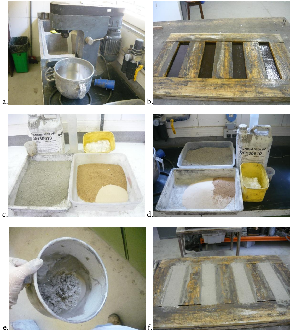
Figura 4.9: Sequência que mostra o lançamento das misturas alternativas de ECC nas formas: (a) argamassadeira; (b) formas; (c-d) materiais para a concretagem; (e) ECC após terminar a mistura; (f) material nas formas. Fonte: fotos do autor.
