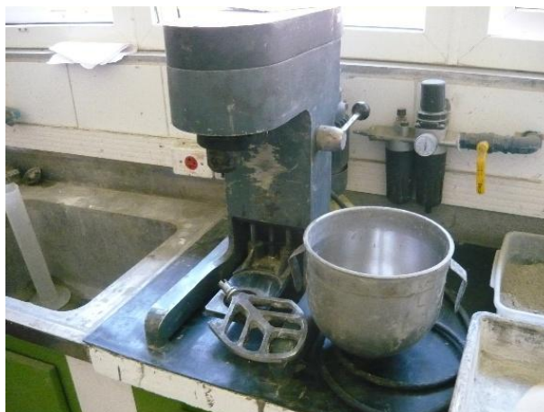
Figura 4.1: Betoneira de eixo vertical, baixo volume de capacidade. Fonte: foto do autor.
