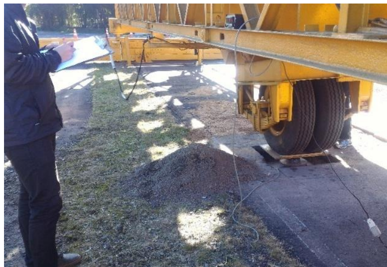
Figura 3.30: Execução da calibração do sistema de carga do simulador. Fonte: foto do autor.
