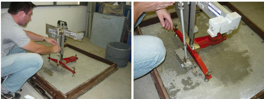
Figura 4.7: Execução do ensaio de Pêndulo Britânico na placa. Fonte: fotos do autor.
