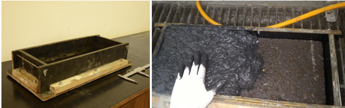
Figura 3.17: Forma e exemplo de concretagem para ensaios de aderência. Fonte: fotos do autor.
