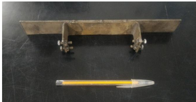
Figura 3.22: Chapa de aço para referência dos LVDT's na medição das deflexões. Fonte: foto do autor.
