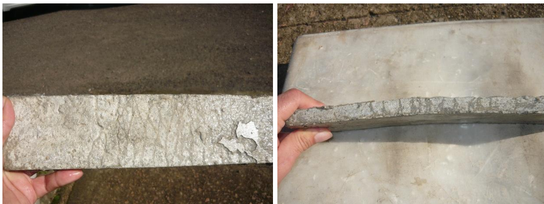
Figura 4.14: Corpos de prova ensaiados, notam-se as microfissuras. Fonte: fotos do autor.
