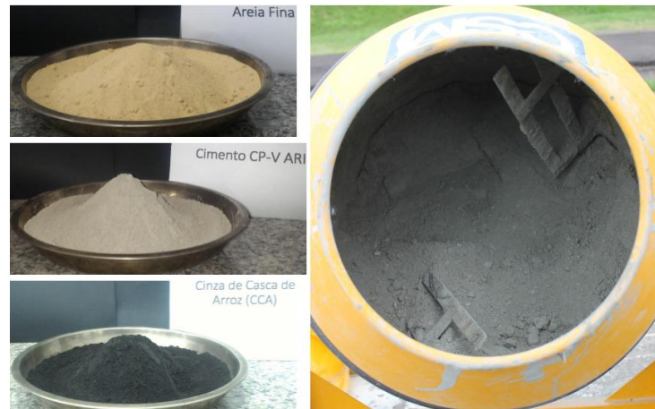
Figura 3.12: Processo de mistura, materiais secos. Fonte: fotos do autor.
