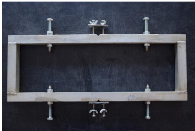
Figura 3.20: Pórtico para posicionamento dos LVDT's. Fonte: foto do autor.
