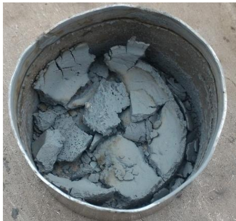
Figura 5.47: Material surgido na superfície do recapeamento com espessura de 50 mm, secado ao forno. Fonte: foto do autor.
