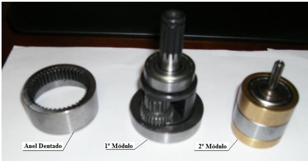
Figura 4.62: Peças da Transmissão Planetária da 1ª proposta do Motor Pneumático.
