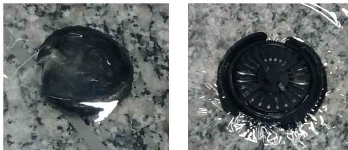
Figura 4.7 – Corpo de prova para medição de propriedades reométricas não vulcanizado (esquerda) e vulcanizado (direita).
