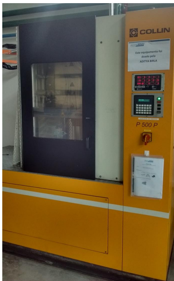
Figura 4.10 – Prensa Collin P500P utilizada para vulcanização das placas para ensaio de tração.
