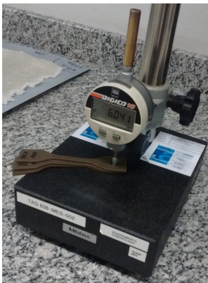
Figura 4.13 – Micrômetro para medição de espessura.
