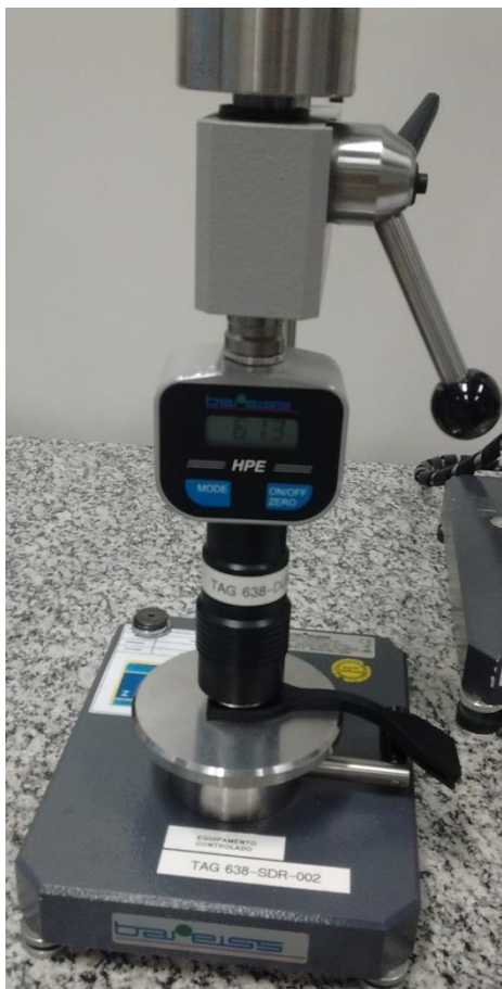
Figura 4.14 – Equipamento para medição de dureza Shore A.
