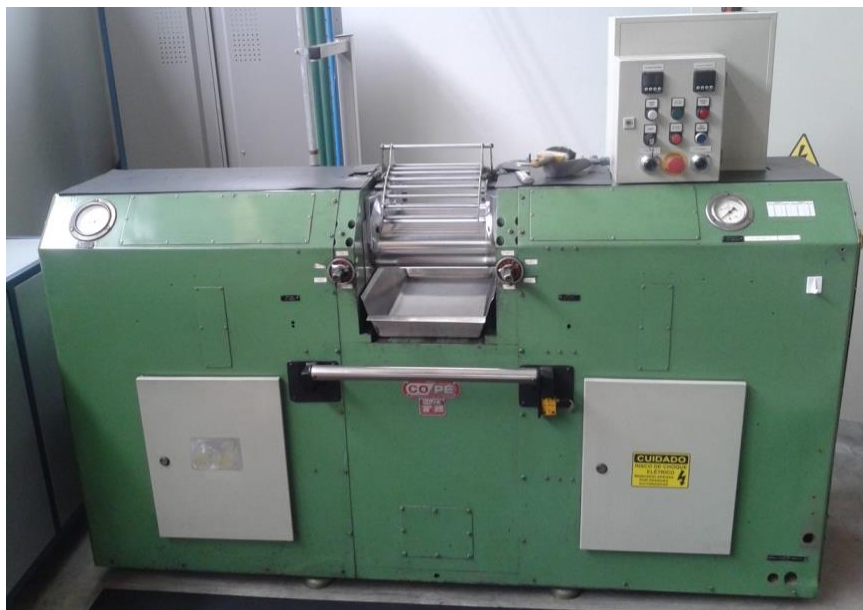
Figura 4.4 – Misturador aberto de cilindros COPÉ .
