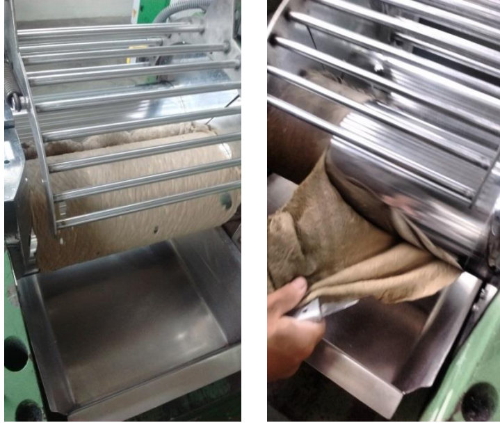
Figura 4.5 - Processamento da borracha no misturador aberto.
