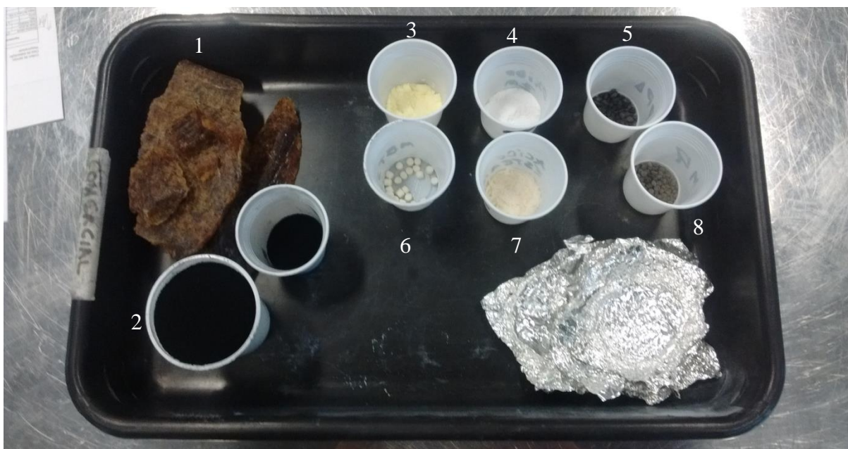
Figura 4.1 – Ingredientes do Composto 2 após a pesagem. Borracha natural (1), negro de fumo (2), agente de cura/enxofre (3), ativador de cura/óxido de zinco (4), antioxidante/6PPD (5), acelerador/MBTS (6), ativador de cura/ácido esteárico (7), antiozonante/TMQ (8).
