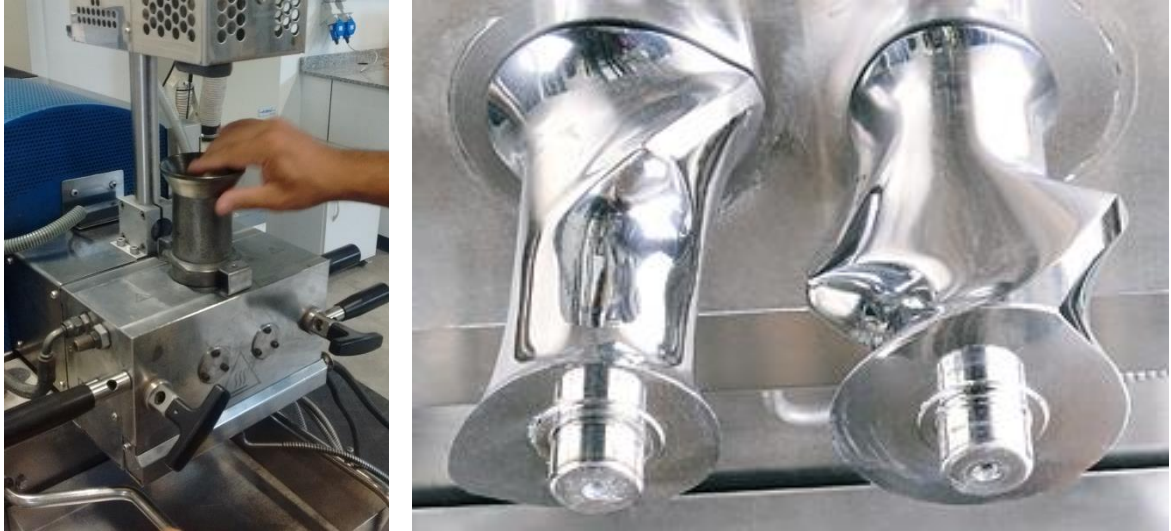
Figura 4.3 – Câmara de mistura do HAAKE da Polylab System utilizada para o processamento dos compostos à esquerda e detalhe dos rotores do tipo tangencial à direita.
