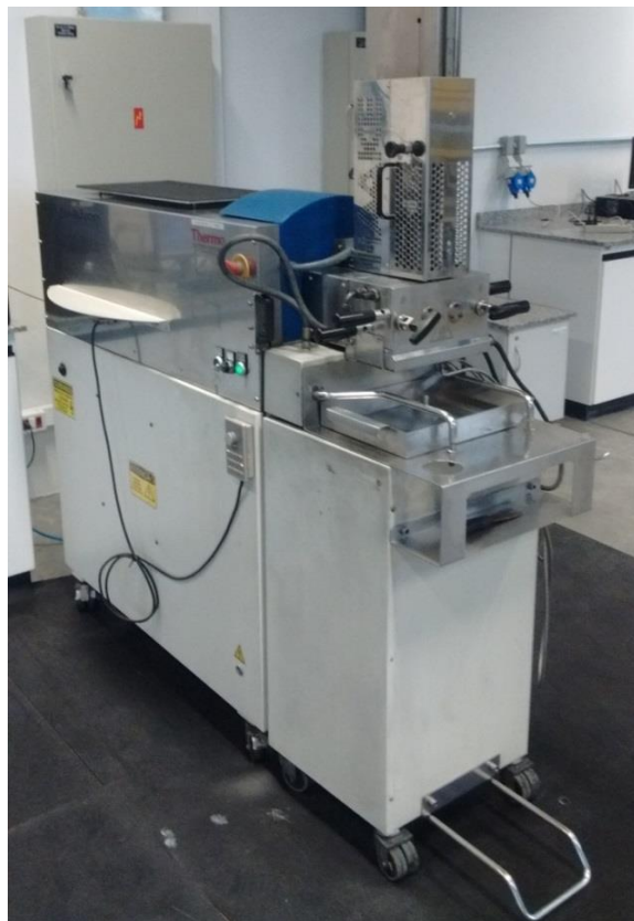
Figura 4.2 – HAAKE da Polylab System utilizada para o processamento dos compostos.
