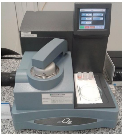
Figura 4.8 – Equipamento DSC (Differential Scanning Calorimeter) para medição de propriedades térmicas das borrachas.
