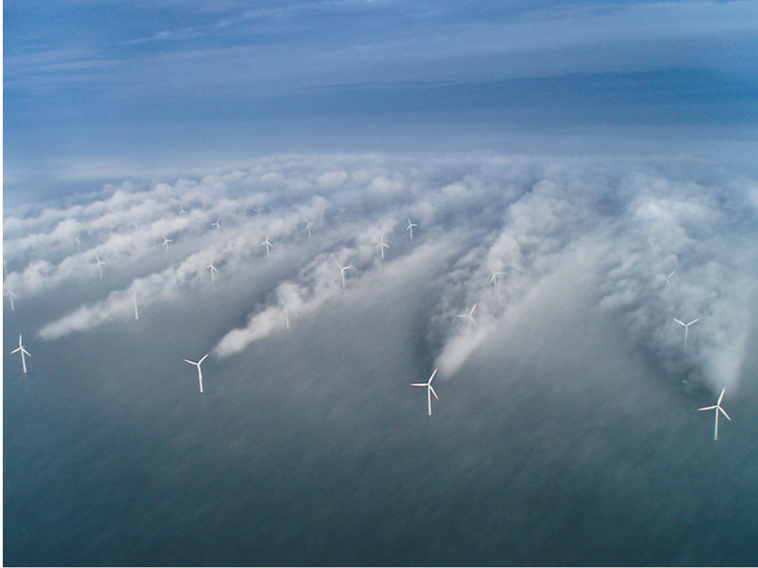
Figura 2.15 – Fazenda eólica offshore de Horns Rev, Dinamarca. O efeito de esteira pode ser visualizado [Retirado de Steiness, 2014].
