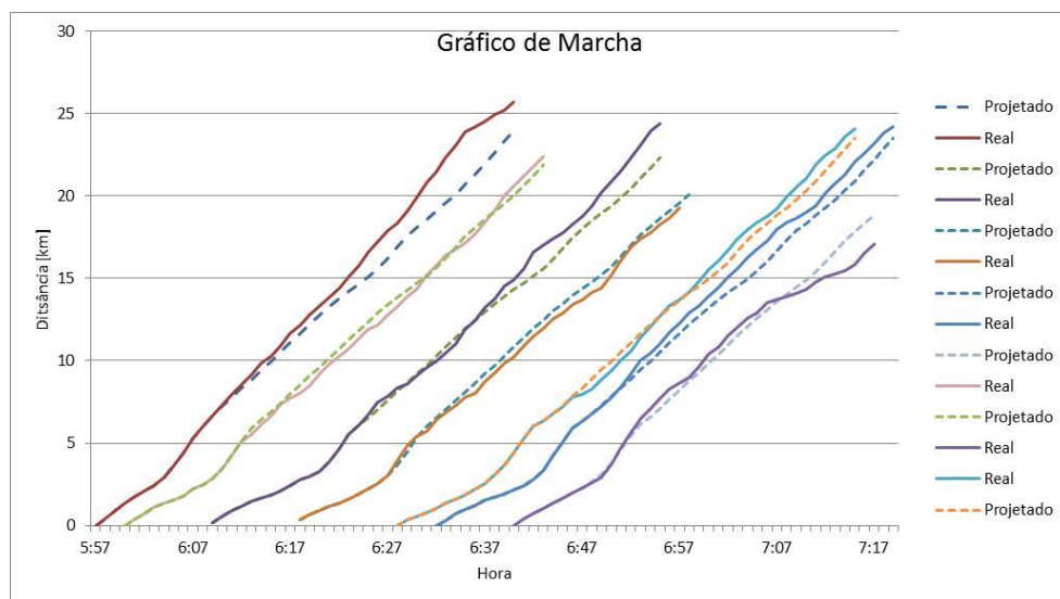
Figura 21- Gráfico de Marcha da trajetória real vs a trajetória projetada de veículos
