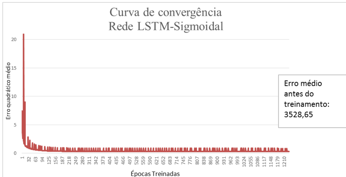
Figura 16 - Curva de convergência da rede no processo de aprendizagem
