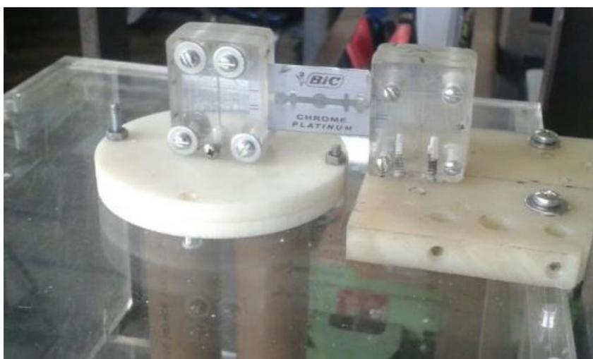
Figura 4.10 – Elemento mola fixado no eixo da base.
