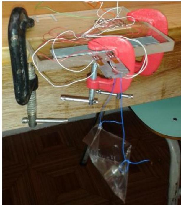
Figura C.1 – Calibração do elemento mola.
