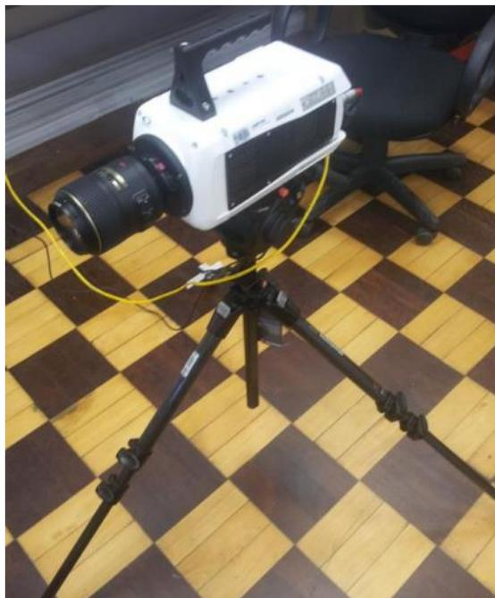
Figura 4.11 – Câmera de alta velocidade com lente acoplada e tripé de fixação.
