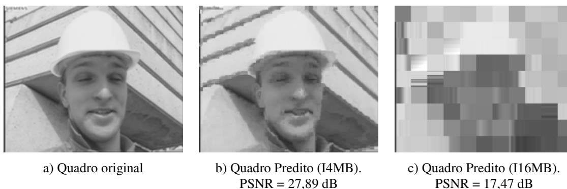
Figura 4.19: Resultados do software de predição intra-quadro para um quadro da sequência de vídeo ‘Foreman’ (QCIF).
