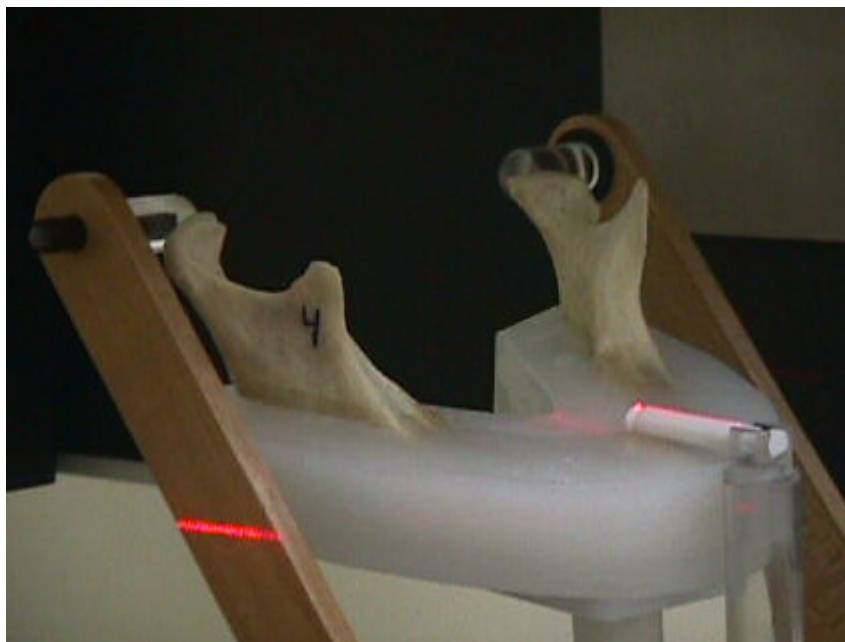
FIGURA 2. Mandíbula posicionada para a obtenção de imagens por tomografia hipocicloidal.
