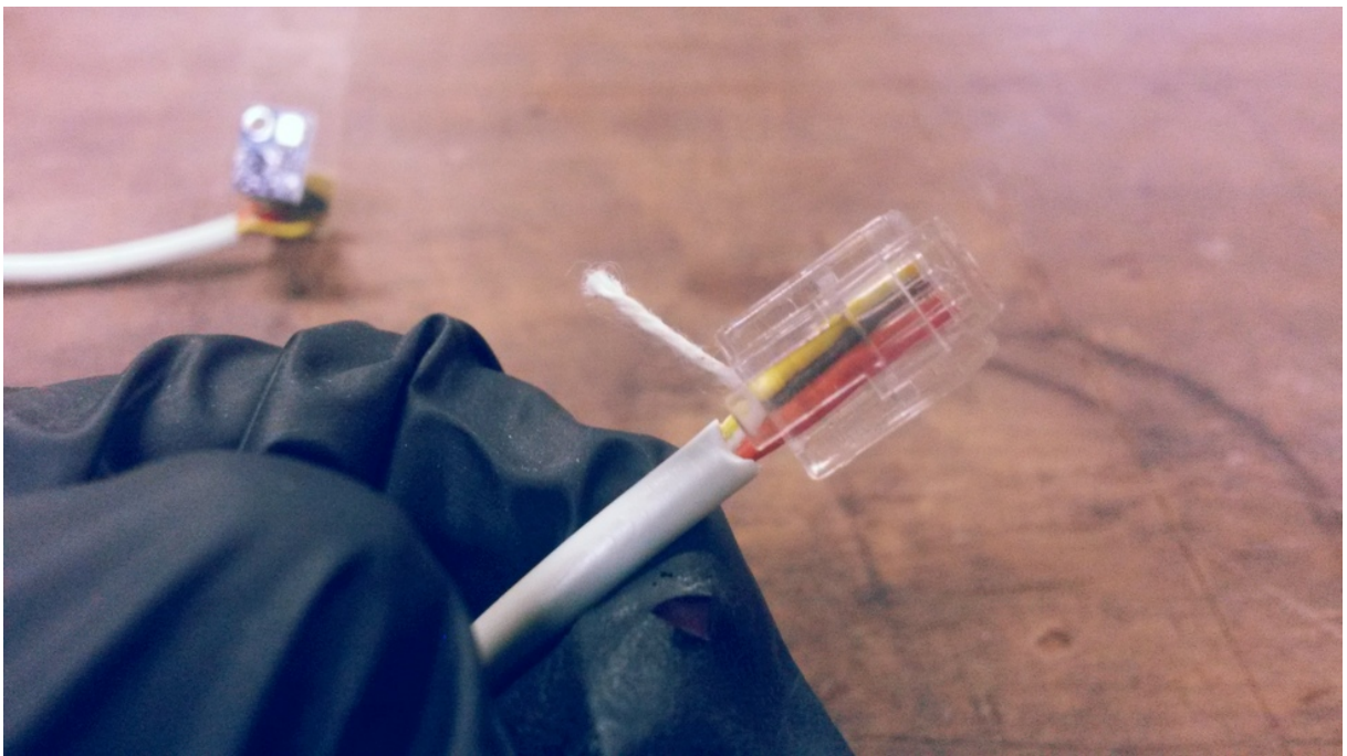
Figura 56. Cabo de sensor de pressão atmosférica e temperatura preparado para ser crimpado durante Encontro de Fabricação Colaborativa. Fonte: Leonardo Sehn (2017).
