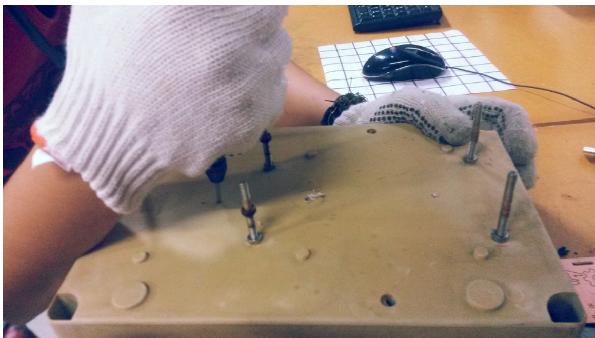
Figura 59. Participante de Mutirão das EMM realiza processo de perfuração de caixa estanque com minirretífica. Fonte: Leonardo Sehn (2018).
