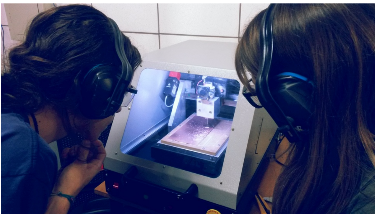
Figura 52. Participantes de Encontro de Fabricação Colaborativa acompanham usinagem da placa de controle das EMM. Fonte: Leonardo Sehn (2017).
