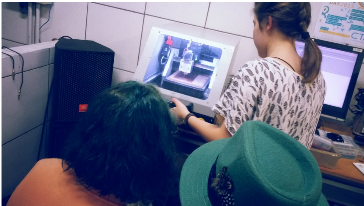
Figura 7. Participantes de Encontro de Fabricação Colaborativa realizam processos de usinagem da placa de controle das EMM. Fonte: Leonardo Sehn (2017).
