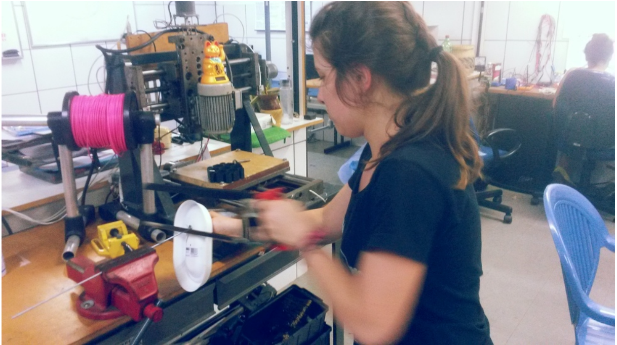
Figura 60. Participante do Mutirão das EMM serra barra rosqueada usada em abrigo de luminosidade. Fonte: Leonardo Sehn (2018).
