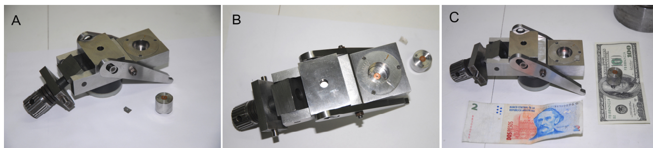
Figura 3.13: Fotografia da câmara de bigorna de diamantes. A: vista lateral, B: vista superior, e C: referência de tamanho.
