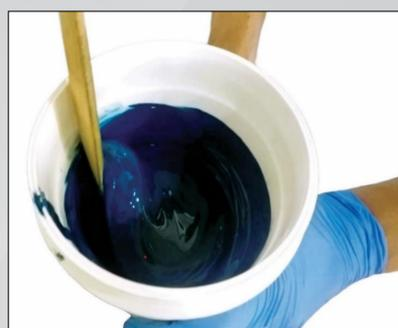
Visualização do processo de mistura com detalhe na alta viscosidade da resina
