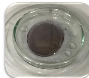
Figura 4 - Biofilme com 0,16g de RBC RA2 e 4g de gelatina em contato com vapor de amônia. A cor roxa aparece em poucos minutos. ✨
