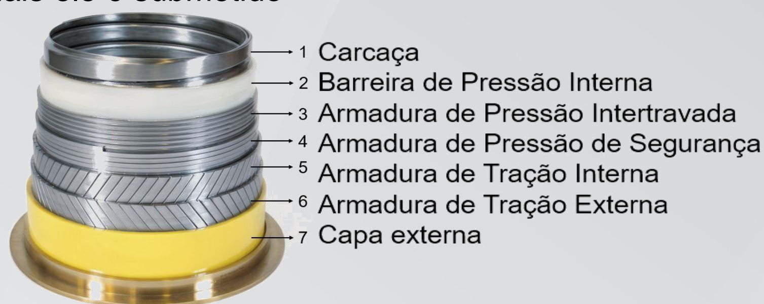
Figura 1: Camadas de um duto flexível
