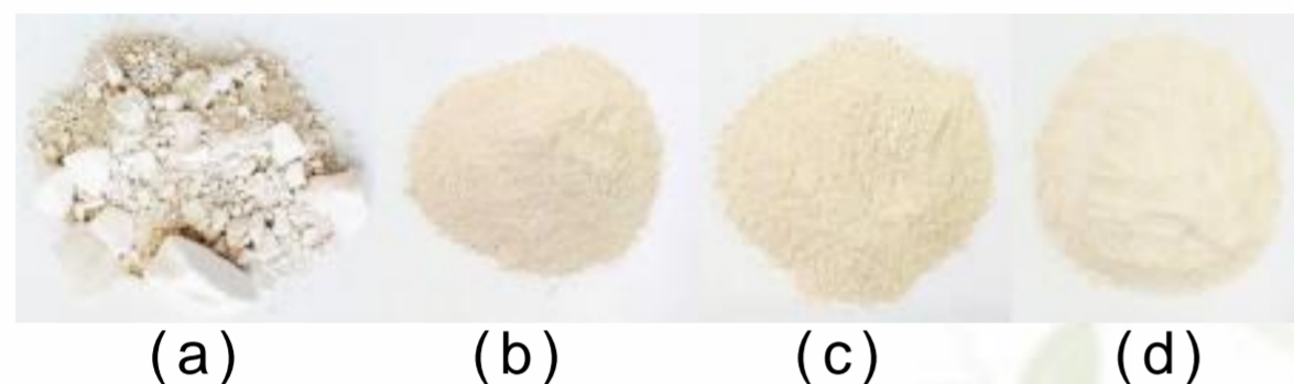
Lodo de Caulim LCC: (a) Estado inicial (b) Pós pré-moagem (c) Pós calcinação (d) Estado final, pós moagem
