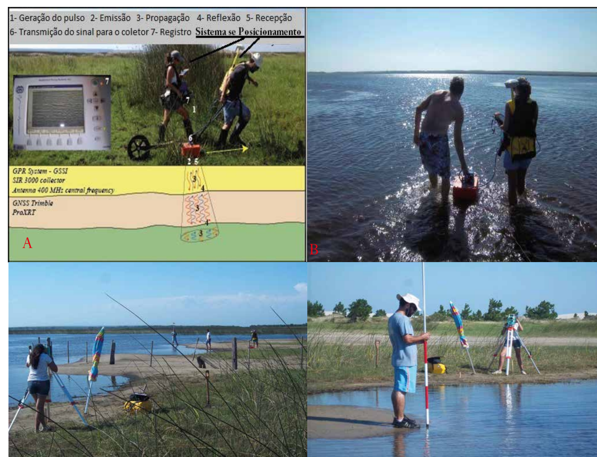
Figura 3 ((A) e (B) Levantamento das seções de georradar; (C) e (D) Levantamento com estação total para correção topográfica das linhas de GPR.)
