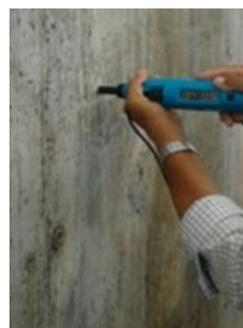
Figura 5 - Ensaio de esclerometria
