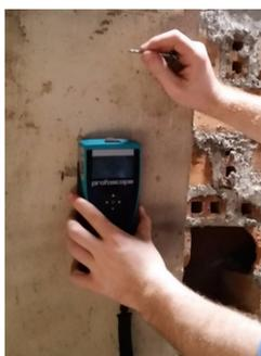
Figura 3 - Ensaio de pacometria
