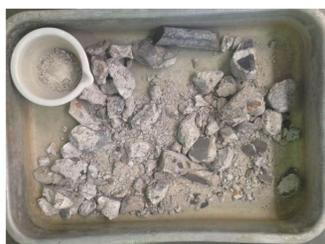
Figura 2 - Preparação da amostra para reconstituição de traço
