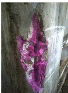
Figura 4 - Ensaio de carbonatação
