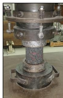
Ensaio de resistência à compressão axial com Neoprene
