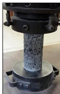
Ensaio de resistência à compressão axial com Argamassa
