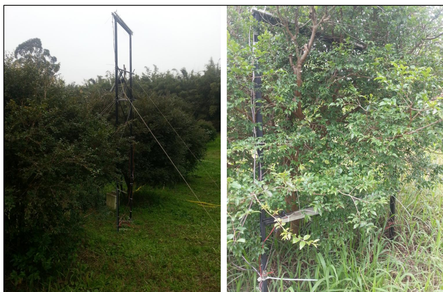
Figura 1. Localização dos sensores para medir RFA incidente acima da copa (esquerda) e RFA transmitida no meio e na base da copa de jabuticabeiras. Porto Alegre, 2016/2017.
