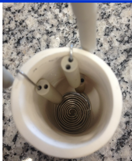
Figura 1: Cadinho de alumina contendo o ânodo de aço e o cátodo de Ni-Cr
