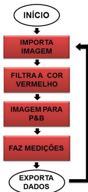
A fase experimental do estudo consiste na divisão de um canal de acrílico em dois, com o uso de uma chapa de ferro e preenchendo somente um lado com água, simulando uma barragem. Para melhor visualização do fenômeno e melhor reconhecimento da onda por parte do programa, é utilizado corante vermelho na água e um fundo branco. A chapa de ferro é retirada rapidamente para a simulação de uma ruptura, e a onda gerada é filmada com o uso de uma câmera de alta velocidade.
