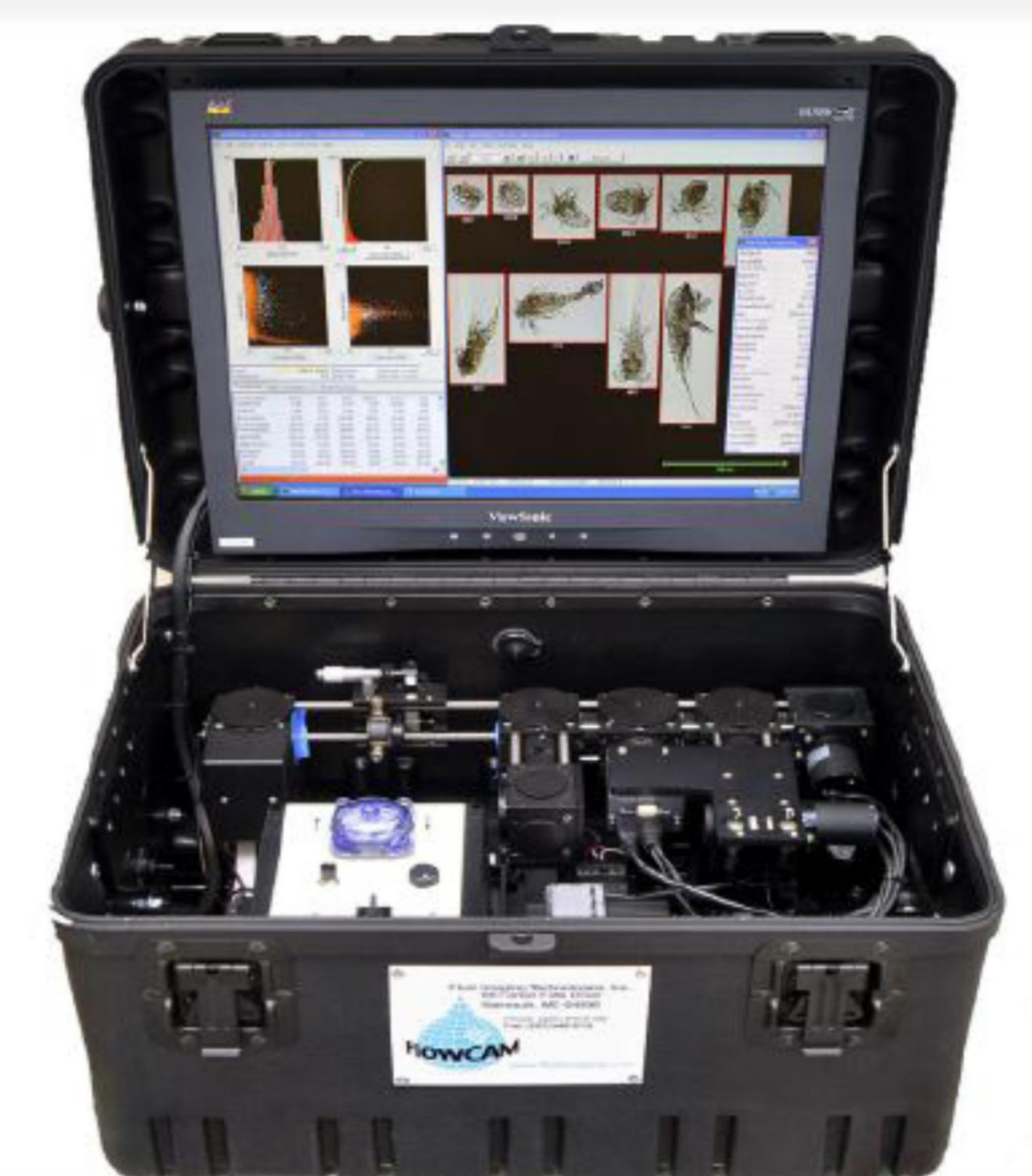
Fig. 2. Microscópio invertido e câmaras de sedimentação de 2 ml, 5 ml e 10 ml, respectivamente. Fig. 3. Equipamento automático de fluxo contínuo, FlowCAM .
