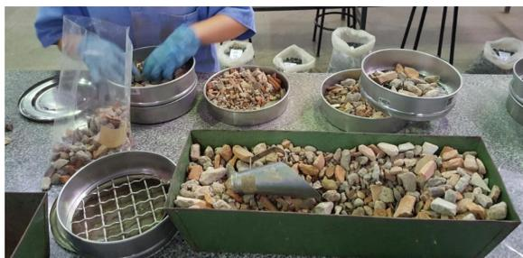
A primeira etapa da pesquisa constituiu em peneirar o material de RCD, coletado em uma empresa gerenciadora de entulho em Montenegro - RS, selecionando os passantes na malha 19 mm e retido na peneira de malha 4,75mm. Foram também retiradas algumas possíveis impurezas do material.
