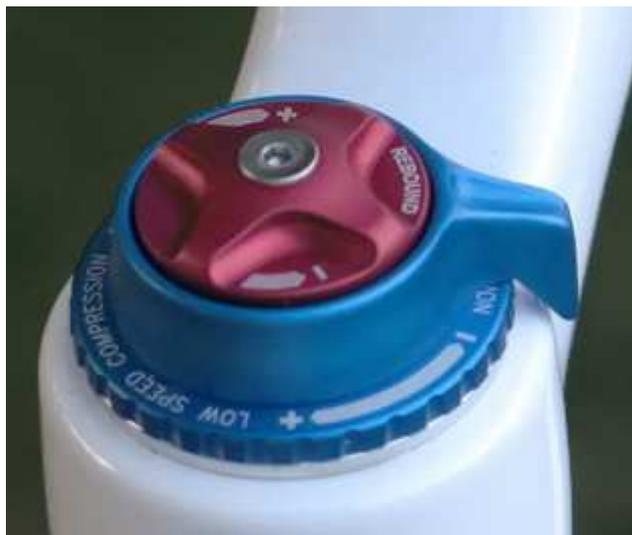
Figura 27. Acionador integrado das regulagens de amortecimento do retorno, amortecimento da compressão e travamento de uma suspensão de bicicleta<sup>20</sup>.
