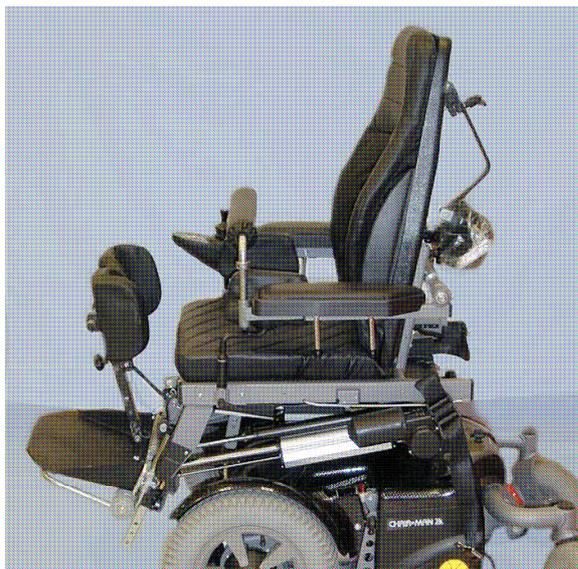
Figura 4. Cadeira de rodas motorizada cujo sistema de assento apresenta posicionadores laterais para a pelve, suporte inclinado para os pés e limitador do deslocamento anterior dos joelhos.
