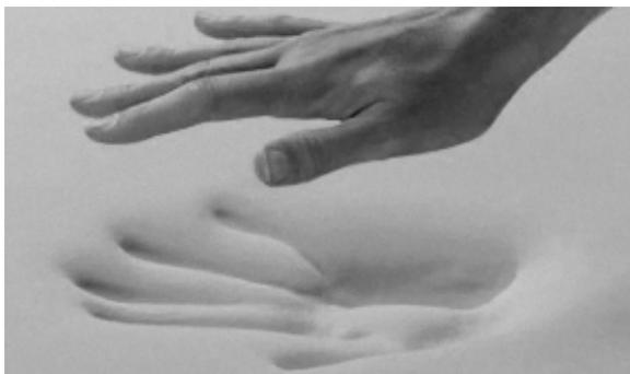
Figura 26. Exemplo de espuma visco-elástica termo-sensível.<sup>19</sup>
