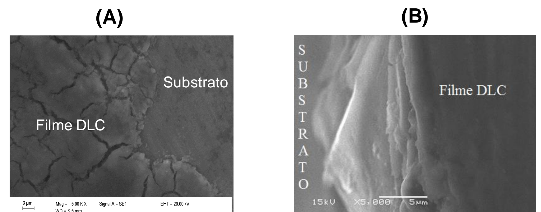
Figura 2 : MEV da superfície da liga AA2024-T3 com camada de DLC eletrodepositada a 800V em DMF (A) e etanol 99,5% (B) com 5000X de aumento.
