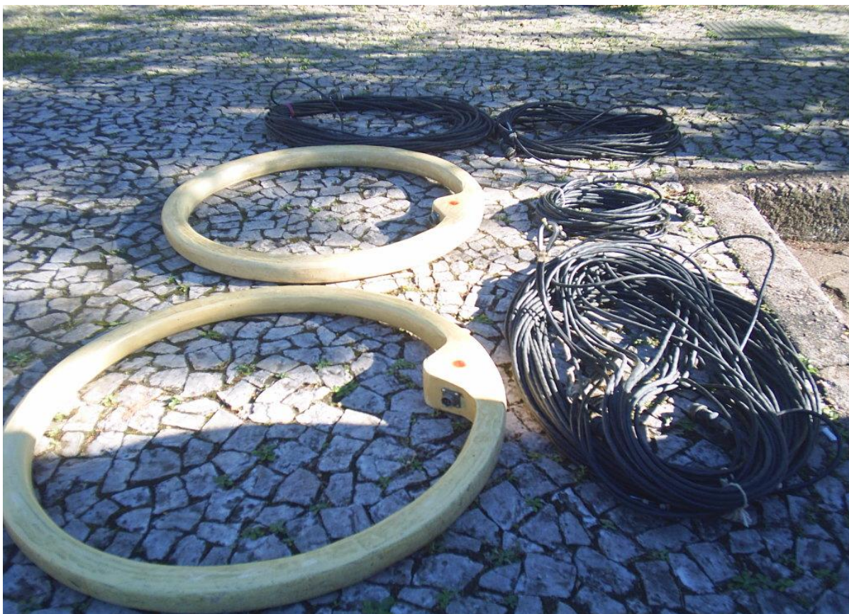
Foto 21: Cabos de 10, 20 e 40m de espaçamento e bobinas transmissora e receptora Fonte: TROLEIS, 2007.
