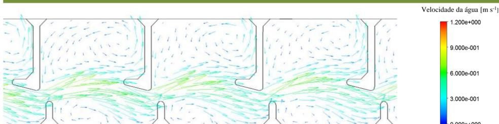
Figura 2: Campos de velocidades médias em 0,50h<sub>m</sub>, sendo h<sub>m</sub> a profundidade média do tanque, para a vazão mássica de 21,59 kg/s.
