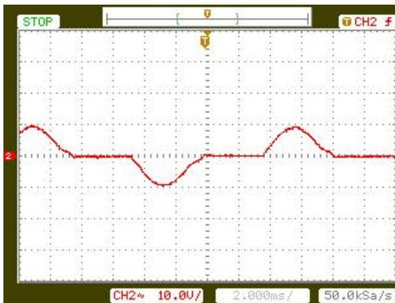
**Figura 4** Forma de onda de Corrente (A) - Motor 1- Carga 0 (LMEAE)
