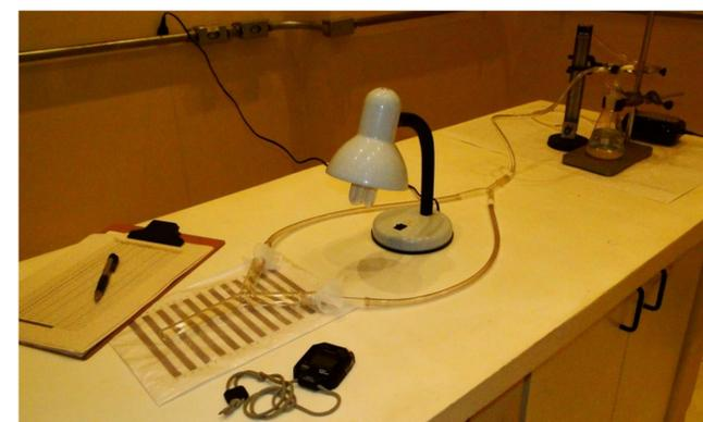
**Figura 3.** Sistema ligado ao olfatômetro.
