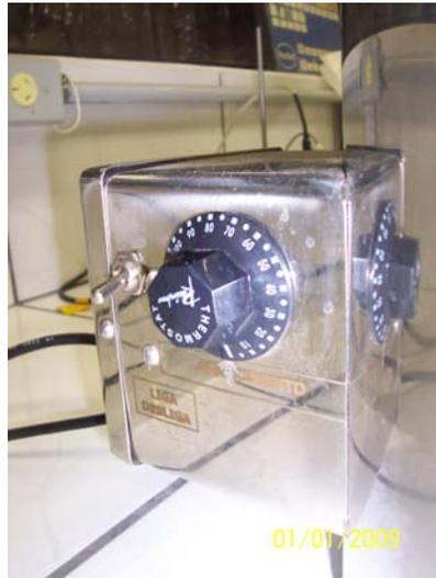
**Figura 3.7:** Termostato do reator
