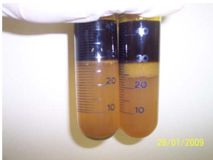
**Figura 4.1:** Comparação entre os resultados extremos obtidos para a quantidade percentual da fase emulsão oleosa
