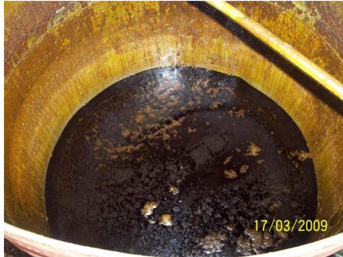
**Figura 4.7:** Camada superior correspondente ao ácido graxo de soja no decantador da unidade piloto
