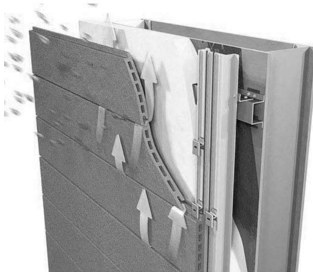
Imagem 31: Sistema de Fachada Ventilada NBK - Hunter Douglas. Permite a utilização do espaço entre alvenaria e painéis para passagem das instalações elétricas, hidráulicas e de ar condicionado, alta durabilidade e o baixo grau de absorção das peças, a infiltração de água é quase que insignificante, aumentando assim a vida útil do edifício.
