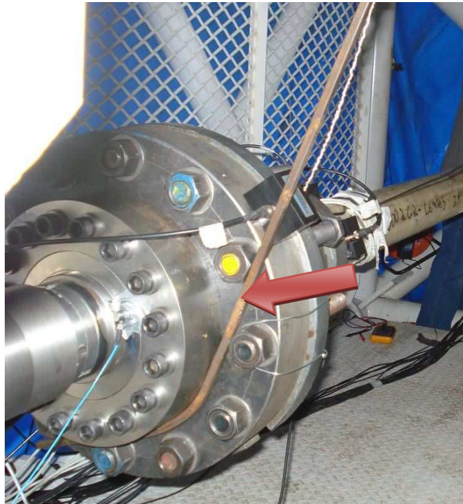
Figura 5.89 – Detalhe do posicionamento da haste do sensor de rotação.
