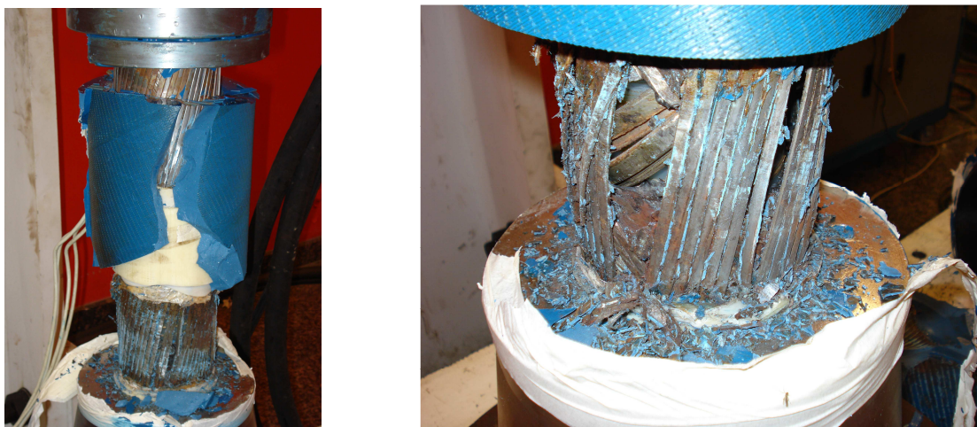
Figura 5.81 – Dano produzido no riser associado ao ensaio de fadiga.
