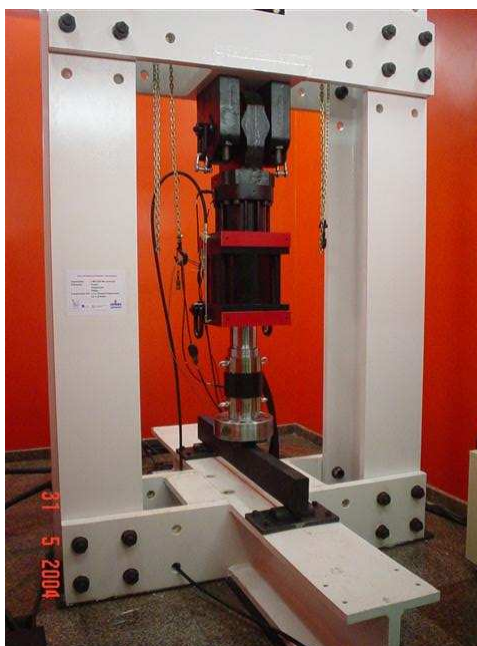
Figura 5.73 – Pórtico com atuador de 1000kN.
