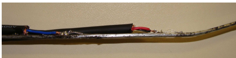
Figura 5.59 – Detalhes da instrumentação feita no arame do modelo proposto.
