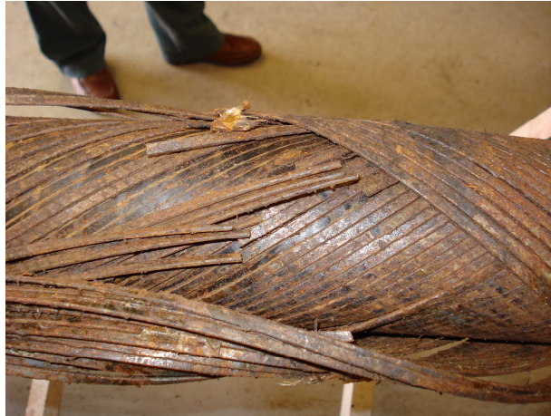
Figura 5.95 – Detalhe dos arames rompidos na região central do CP2.
