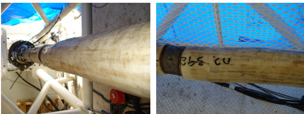
Figura 5.94 – Irregularidades superficiais da capa externa na região central do CP.
