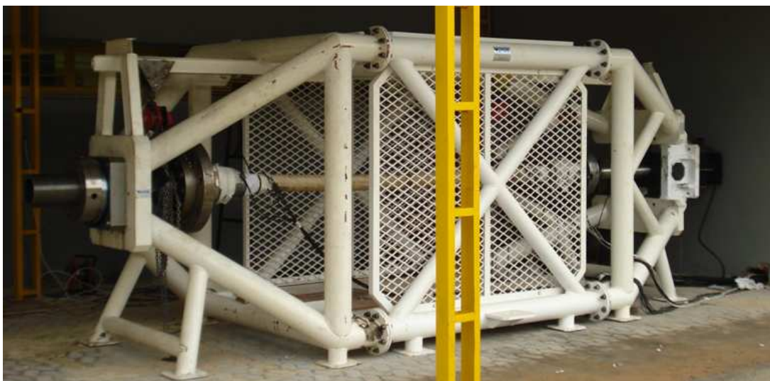
Figura 5.90 – Treliça com atuador de 500 kN e o CP 2 montado.
