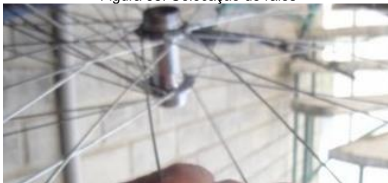
Figura 95: Colocação de raios
