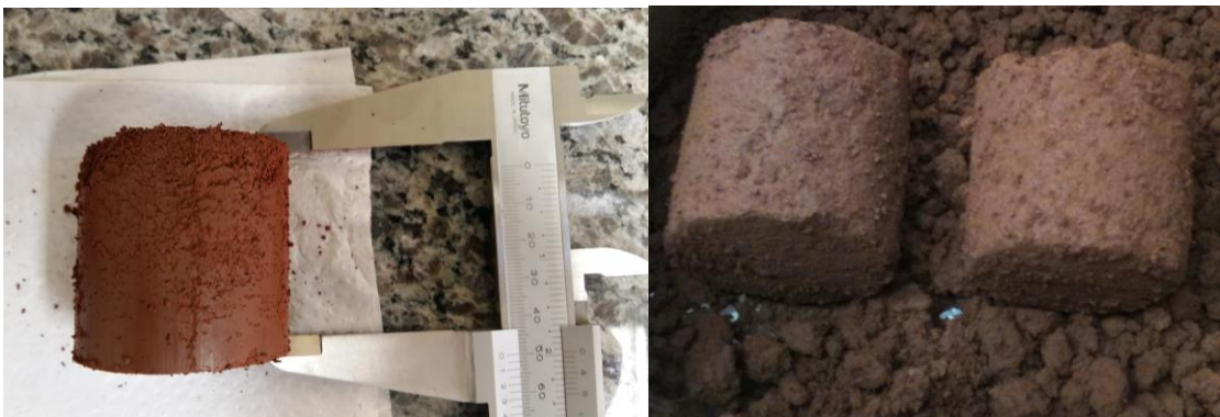
Figura 32: Corpos de prova deformados e indeformados utilizados nos experimentos
