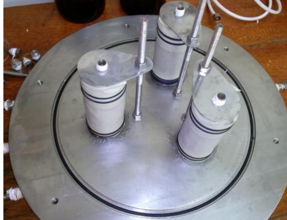
Figura 34: Detalhe da fixação dos corpos de prova na camara principal do equipamento.
