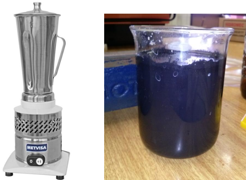
Figura 28: Equipamento utilizado para ativação e a suspensão pronta
