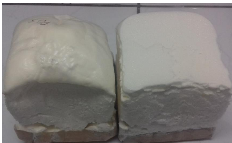
Figura 27: Fissuras formadas nas bases das EFPUs produzidas.
