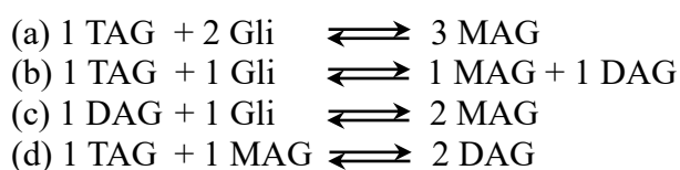
Figura 9: Reações reversíveis que ocorrem na glicerólise.
