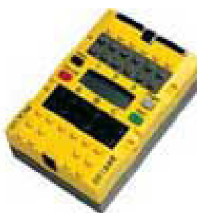
Figura 14 – Bloco Programável RCX
