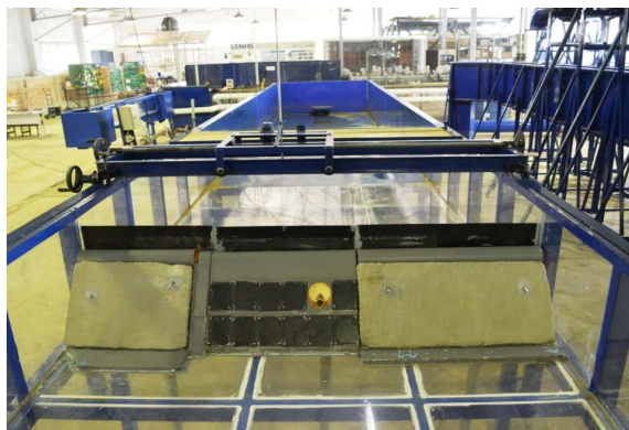
Figura 6. Vista lateral do modelo com descarga de fundo aberta na posição 12.
