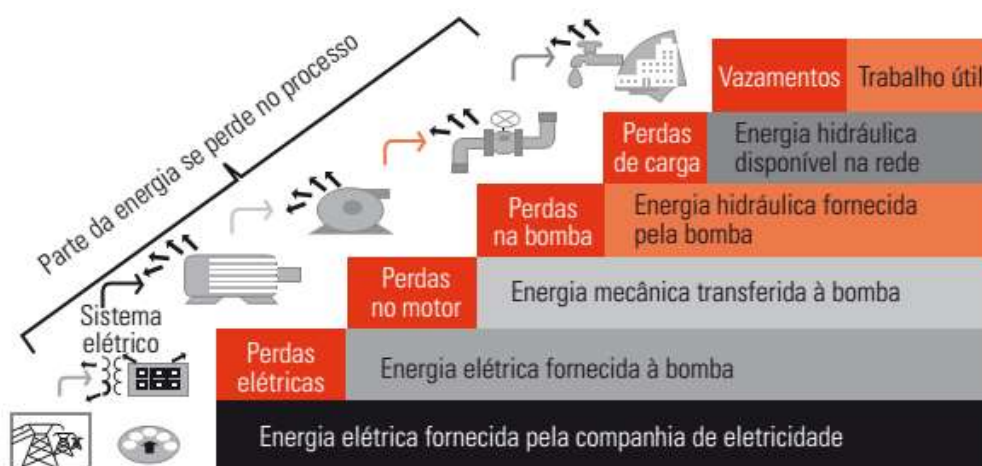
Figura 3. Exemplo de esquema para representar a perda de energia em SAA (Banco Interamericano de Desenvolvimento, 2011).
