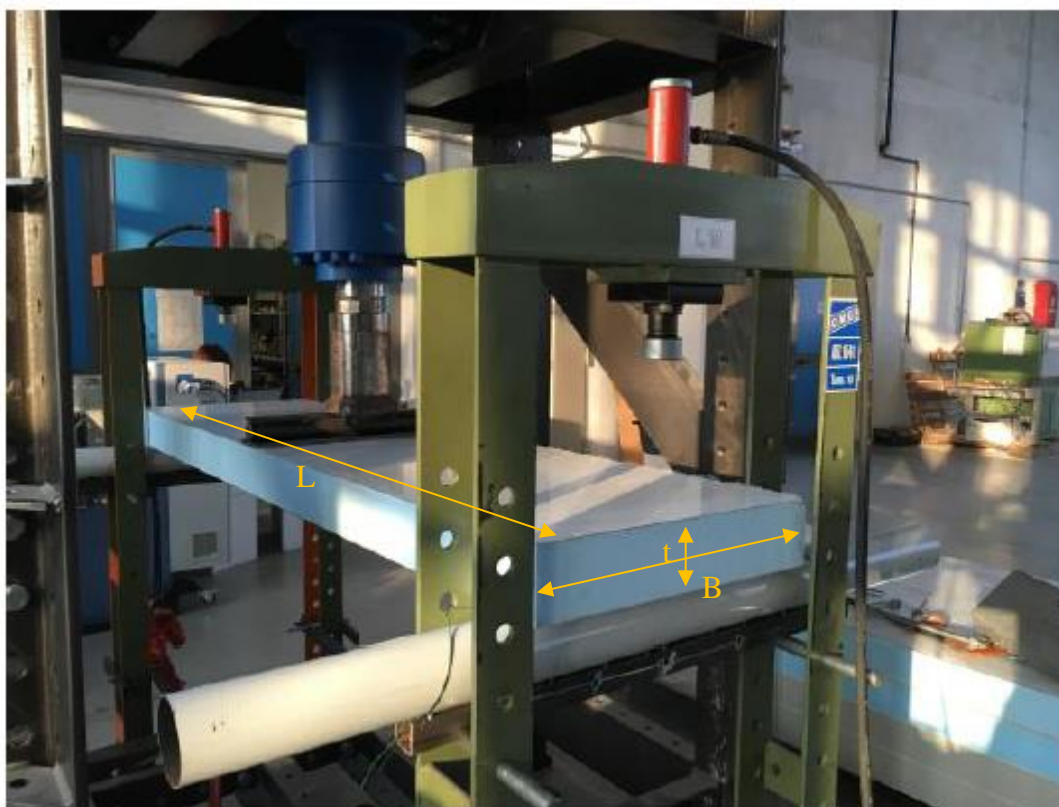
Figura 4.234 - Painel de Sanduiche: Propriedades geométricas, condições de contorno (Ventadori 2017).
