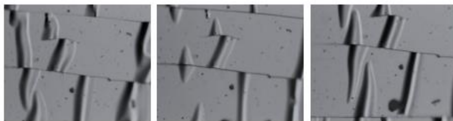
Figura B.3 - Configurações de ruptura em filmes finos onde o substrato sofre uma variação da temperatura impondo deslocamentos prescritos sobre o filme e induzindo sua flambagem.
