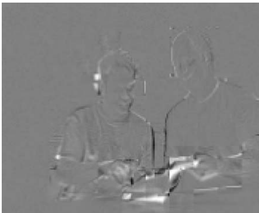
Figura 3.11: Resíduo com estimação de movimento de blocos de 16 \times 16 pixels (RICHARDSON, 2003).
