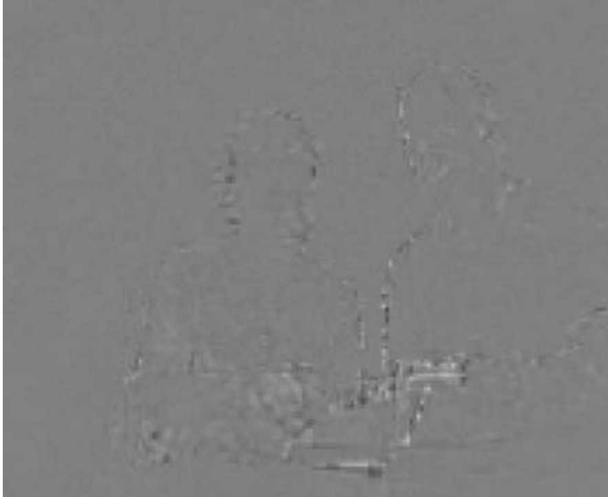
Figura 3.15: Resíduo com estimação de movimento de blocos de 4 \times 4 pixels com precisão de meio- pixel (RICHARDSON, 2003).
