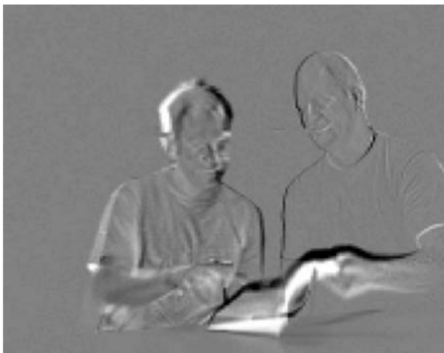
Figura 3.4: Resíduo sem estimação de movimento (RICHARDSON, 2003).
