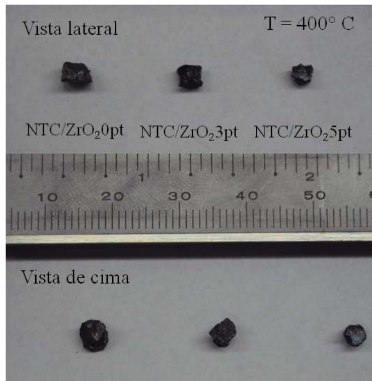
Figura 5.4: Amostras NTC/ZrO 2 após processamento em alta pressão/temperatura.
