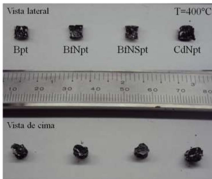
Figura 5.2: Amostras de NTCPM após processamento em alta pressão/temperatura.
