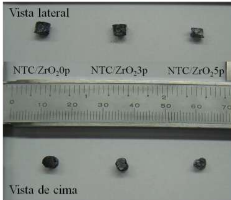
Figura 5.3: Amostras de NTC/ZrO 2 após processamento em alta pressão.
