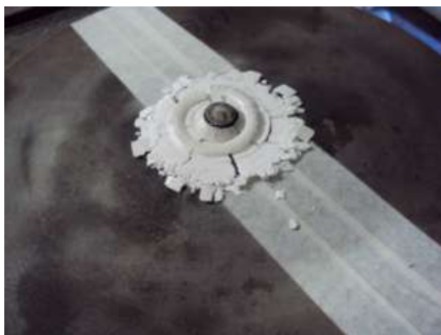
Figura 4.6: Deformação e quebra da gaxeta após a aplicação de alta pressão.
