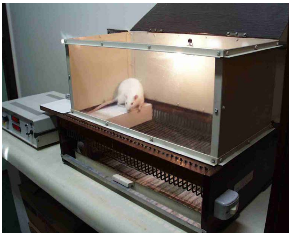
Figura 3.3: Esquiva Inibitória (EI).Caixa de condicionamento automatizada utilizada na tarefa da EI.
