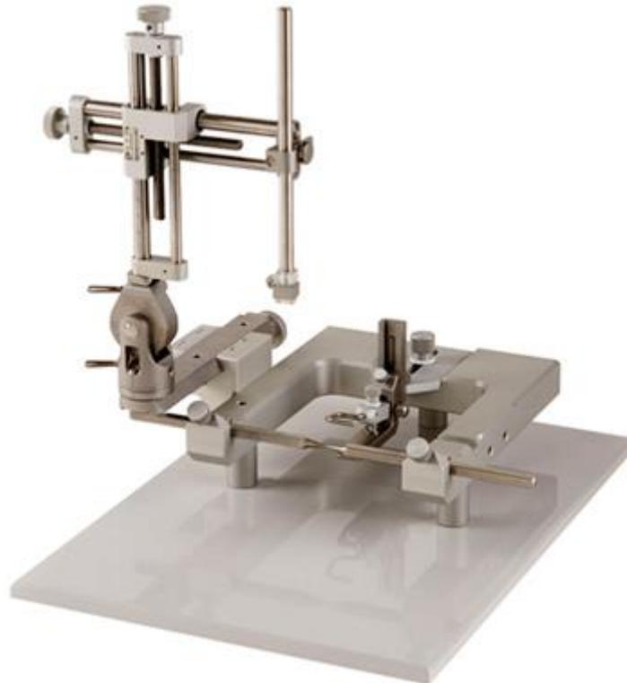
**Figura 5: Aparelho estereotáxico utilizado nas cirurgias para implantação de cânulas.**
