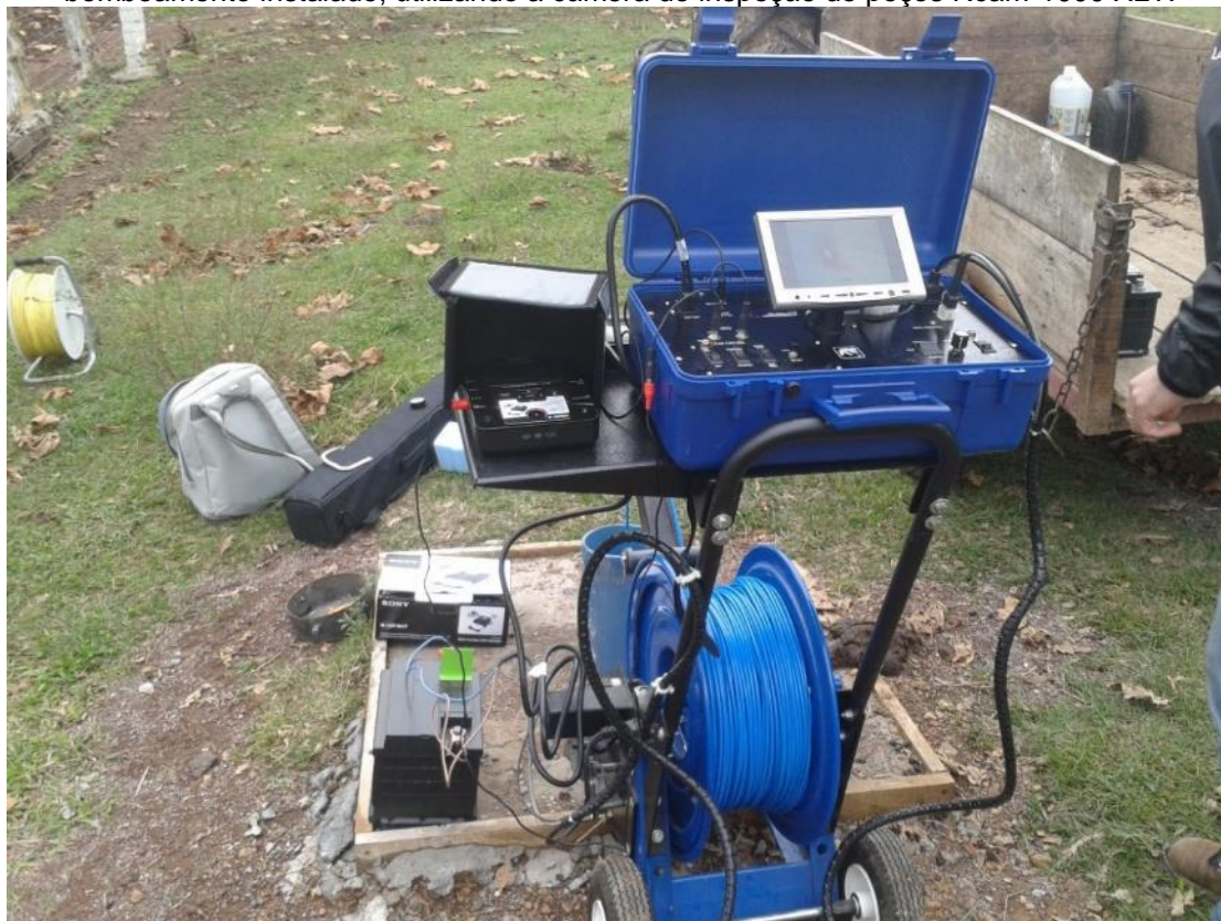
Fotografia 1 – Perfilagem óptica sendo realizada em um dos poços tubulares sem sistema de bombeamento instalado, utilizando a câmera de inspeção de poços Rcam-1000 XLT.
