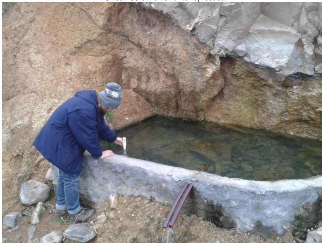
Fotografia 2 – Medição de dados hidroquímicos utilizando uma sonda multiparâmetros Eutech PCTestr 35 em uma fonte represada.
