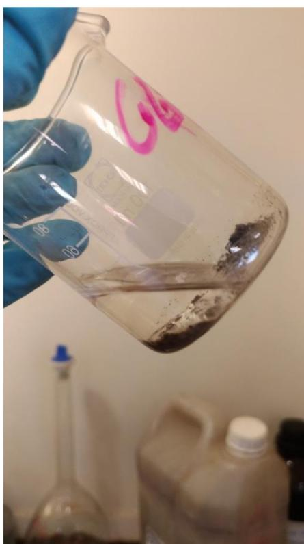
**Figura 8** - Amostras em solução tampão de ácido acético e acetato de sódio com pH 5, em banho a 70°C, para remoção de carbonatos
