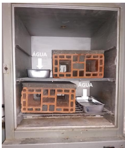
Figura 53 – Amostras de referência dentro da estufa para cura à temperatura de 80°C
