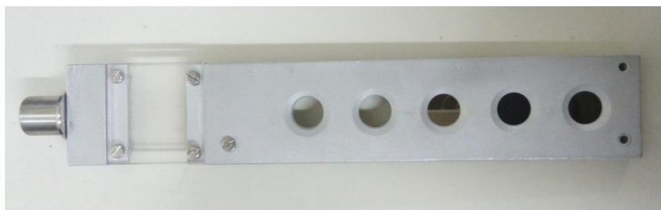
Figura 10: Foto do porta-amostra com capacidade de 5 amostras utilizado em todas as medidas realizadas neste trabalho.
