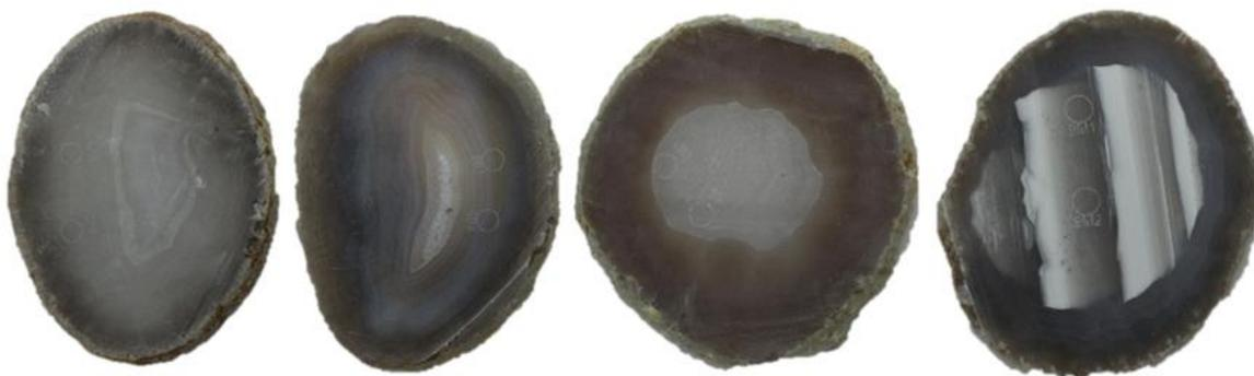
**Figura 59.** Amostras de lâminas de ágata com numeração 9, da categoria “vidrada” (9V1 e 9V2), seguida da categoria “bandada” (9B1 e 9B2), “sal” (9S1e 9S2) e “massa” (9M1 e 9M2), da esquerda para a direita. Amostras antes do tingimento, para a concentração 1.
