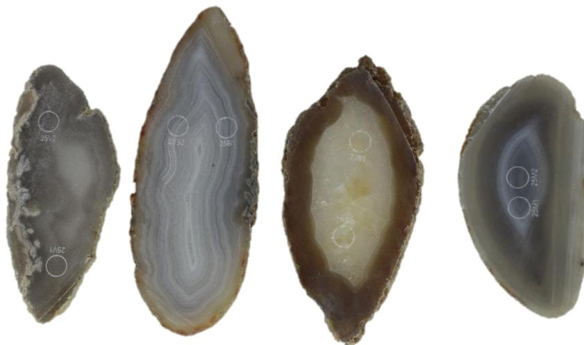
**Figura 148.** Amostras de lâminas de ágata com numeração 25, da categoria “vidrada” (25V1 e 25V2), seguida da categoria “bandada” (25B1 e 25B2), “sal” (25S1e 25S2) e “massa” (25M1 e 25M2), da esquerda para a direita. Amostras anterior ao tingimento em violeta, a partir de corante orgânico, na concentração 3.
