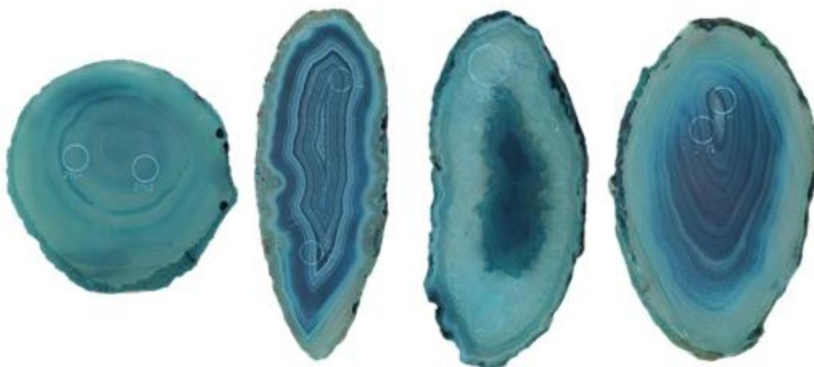
**Figura 128.** Amostras de lâminas de ágata com numeração 21, da categoria “vidrada” (21V1 e 21V2), seguida da categoria “bandada” (21B1 e 21B2), “sal” (21S1e 21S2) e “massa” (21M1 e 21M2), da esquerda para a direita. Amostras submetidas ao tingimento em verde orgânico, para a concentração 2, após tingimento das peças.
