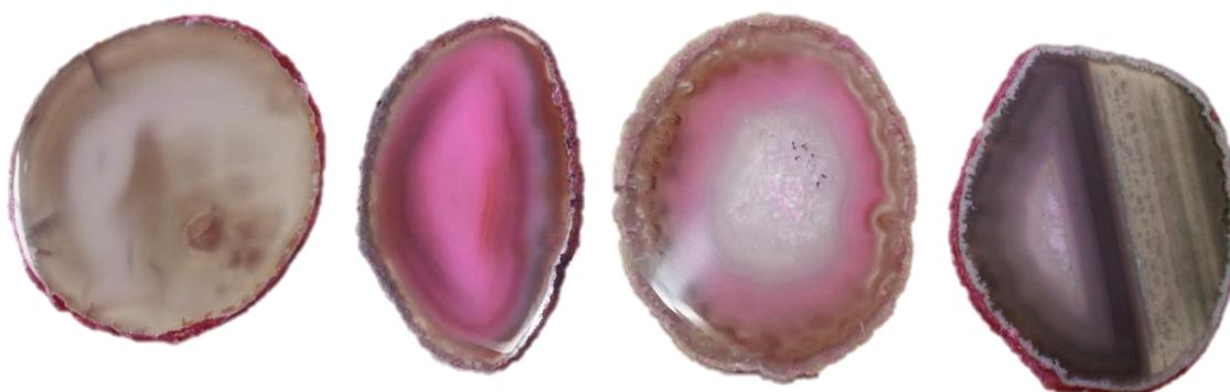
**Figura 106.** Amostras de lâminas de ágata com numeração 17, da categoria “vidrada” (17V1 e 17V2), seguida da categoria “bandada” (17B1 e 17B2), “sal” (17S1e 17S2) e “massa” (17M1 e 17M2), da esquerda para a direita. Amostras submetidas ao tingimento em rosa orgânico, para a concentração 1, após polimento das peças.
