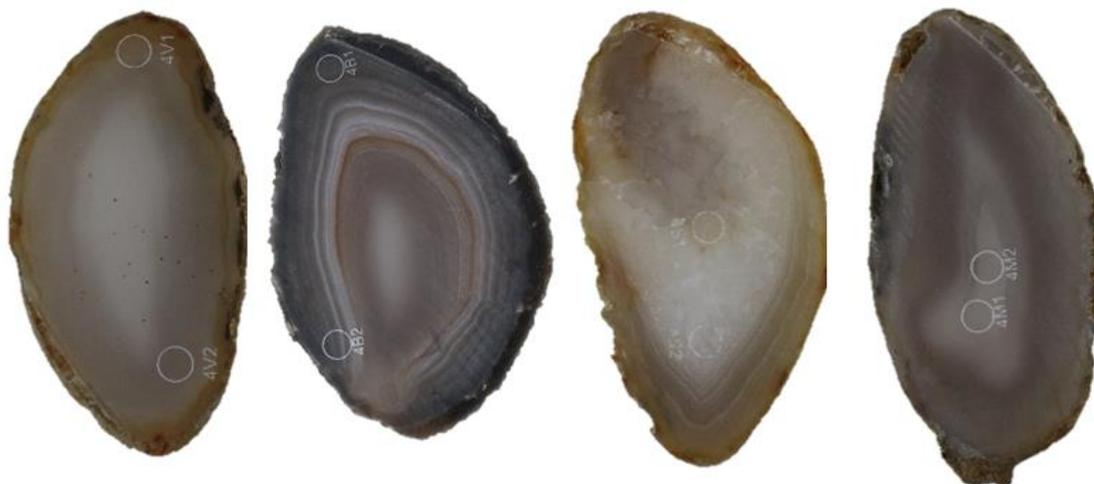
**Figura 50.** Amostras de lâminas de ágata com numeração 4, da categoria “vidrada” (4V1 e 4V2), seguida da categoria “bandada” (4B1 e 4B2), “sal” (4S1e 4S2) e “massa” (4M1 e 4M2), da esquerda para a direita. Amostras antes do tingimento, para a concentração 3.
