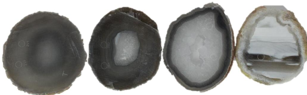
**Figura 68.** Amostras de lâminas de ágata com numeração 2, da categoria “vidrada” (2V1 e 2V2), seguida da categoria “bandada” (2B1 e 2B2), “sal” (2S1e 2S2) e “massa” (2M1 e 2M2), da esquerda para a direita. Amostras antes do tingimento em vermelho.
