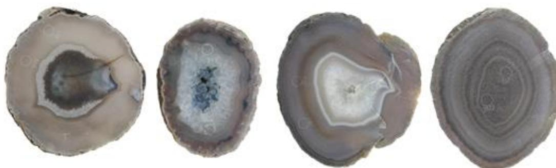
**Figura 84.** Amostras de lâminas de ágata com numeração 3, da categoria “vidrada” (3V1 e 3V2), seguida da categoria “bandada” (3B1 e 3B2), “sal” (3S1e 3S2) e “massa” (3M1 e 3M2), da esquerda para a direita. Amostras após o tingimento, submetidas à pigmentação artificial em azul convencional.
