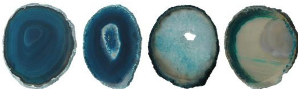
**Figura 134.** Amostras de lâminas de ágata com numeração 7, da categoria “vidrada” (7V1 e 7V2), seguida da categoria “bandada” (7B1 e 7B2), “sal” (7S1e 7S2) e “massa” (7M1 e 7M2), da esquerda para a direita. Amostras submetidas ao tingimento em verde orgânico, para a concentração 4, após polimento das peças
