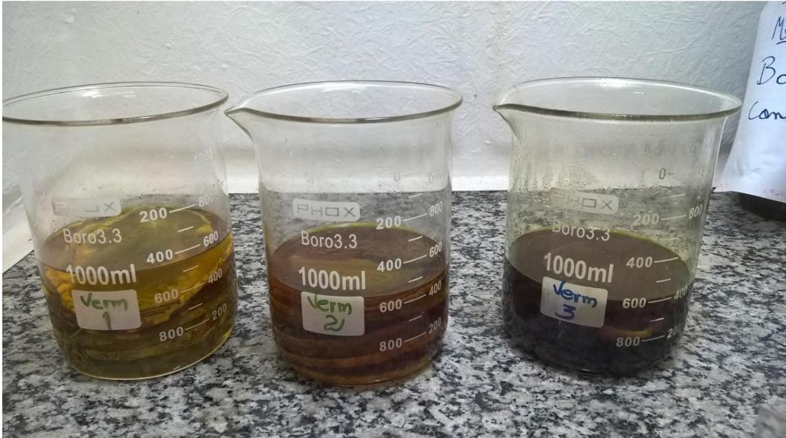
**Figura 31. Lotes de ágatas submetidos ao tingimento otimizado em solução tingidora para cor vermelha, nas concentrações 1, 2 e 3, respectivamente, da esquerda para a direita.**
