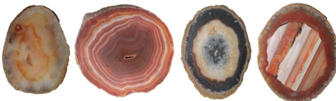
**Figura 66.** Amostras de lâminas de ágata com numeração 8, da categoria “vidrada” (8V1 e 8V2), seguida da categoria “bandada” (8B1 e 8B2), “sal” (8S1e 8S2) e “massa” (8M1 e 8M2), da esquerda para a direita. Amostras após o tingimento, submetidas à pigmentação artificial em vermelho, na concentração 3.
