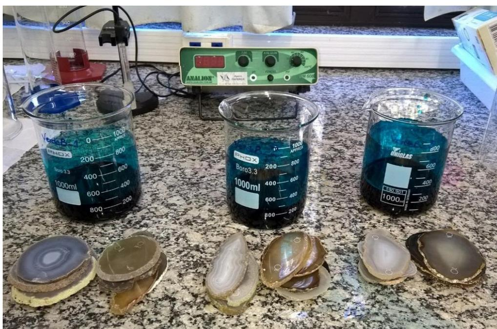
**Figura 40. Vista dos lotes de ágatas submetidos ao tingimento otimizado em solução alcoólica de corante verde brilhante, para as concentrações 1, 2 e 3.**
