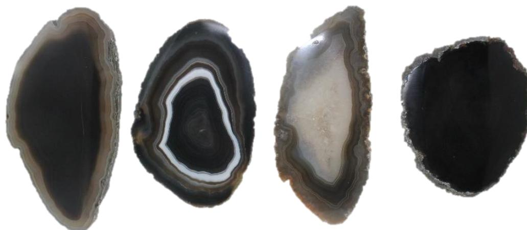
Figura 46. Amostras de lâminas de ágata com numeração 1, da categoria “vidrada” (1V1 e 1V2), seguida da categoria “bandada” (1B1 e 1B2), “sal” (1S1e 1S2) e “massa” (1M1 e 1M2), da esquerda para a direita. Amostras após o polimento, submetidas à pigmentação artificial em preto, na concentração 1.
