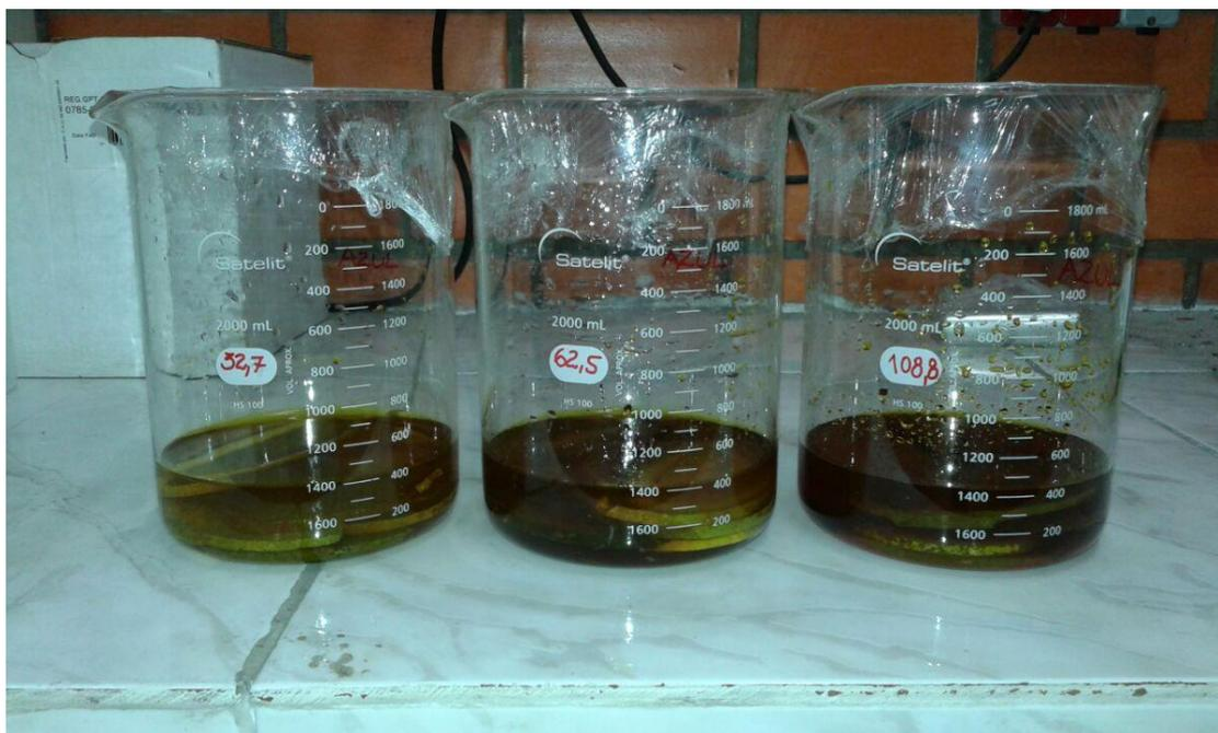
Figura 34. Ágatas imersas em  $\text{K}_3\text{Fe}(\text{CN})_{6(\text{aq})}$  nas concentrações 1, 2 e 3, da esquerda para a direita.
