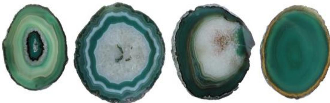
**Figura 94.** Amostras de lâminas de ágata com numeração 15, da categoria “vidrada” (15V1 e 15V2), seguida da categoria “bandada” (15B1 e 15B2), “sal” (15S1e 15S2) e “massa” (15M1 e 15M2), da esquerda para a direita. Amostras após o polimento, submetidas à pigmentação artificial em verde, na concentração 2.
