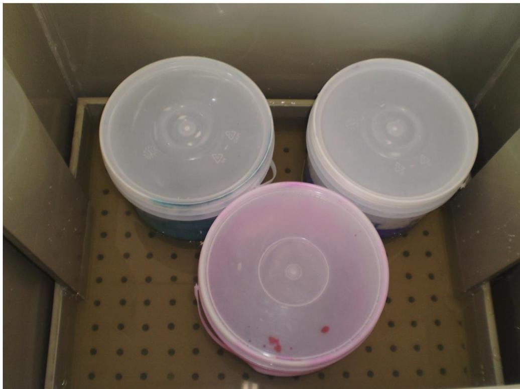
**Figura 26. Tanque de tingimento contendo gemas imersas nas soluções tingidoras para aquecimento em banho maria.**
