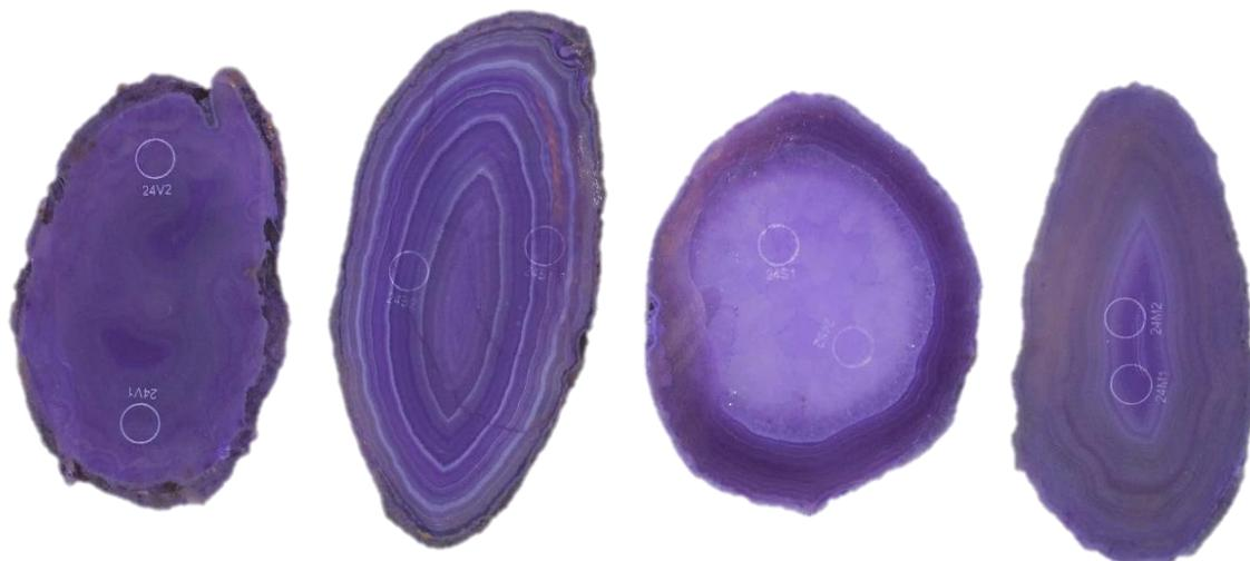
**Figura 146.** Amostras de lâminas de ágata com numeração 24, da categoria “vidrada” (24V1 e 24V2), seguida da categoria “bandada” (24B1 e 24B2), “sal” (24S1e 24S2) e “massa” (24M1 e 24M2), da esquerda para a direita. Amostras após tingimento em violeta, a partir de corante orgânico, na concentração 2.
