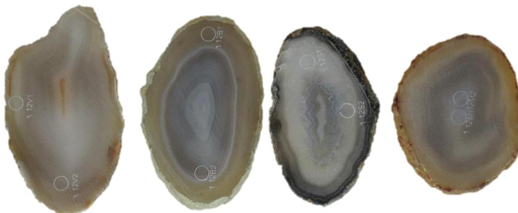
Figura 154. Amostras de lâminas de ágata com numeração 112, da categoria “vidrada” (112V1 e 112V2), seguida da categoria “bandada” (112B1 e 112B2), “sal” (112S1e 112S2) e “massa” (112M1 e 112M2), da esquerda para a direita. Amostras anterior ao tingimento em violeta, a partir de corante orgânico, na concentração 5.
