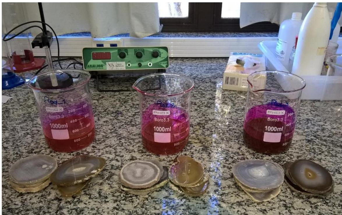
Figura 38. Lotes de ágata submetidos ao tingimento otimizado em solução alcoólica de Rodamina B, para as concentrações 1, 2 e 3, para obtenção da tonalidade rosa.
