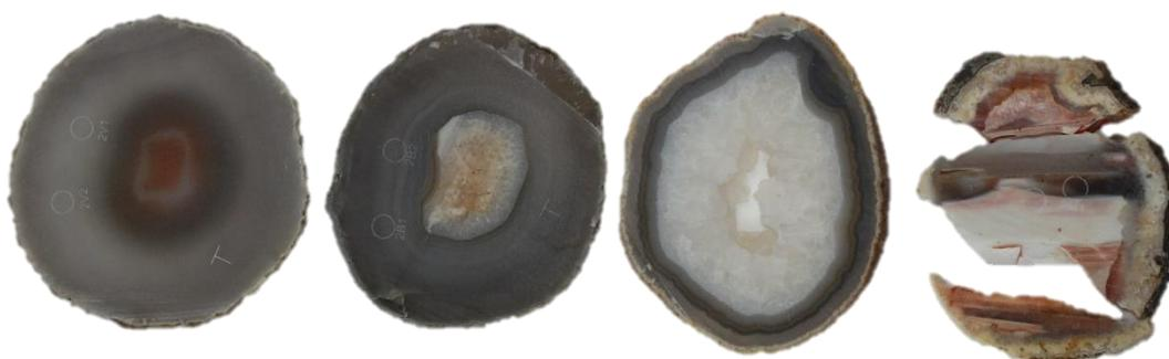
**Figura 69.** Amostras de lâminas de ágata com numeração 2, da categoria “vidrada” (2V1 e 2V2), seguida da categoria “bandada” (2B1 e 2B2), “sal” (2S1e 2S2) e “massa” (2M1 e 2M2), da esquerda para a direita. Amostras após o tingimento, submetidas à pigmentação artificial em vermelho em sistema comercial local.
