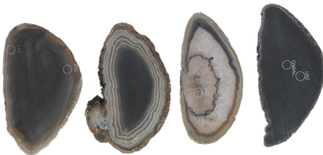
**Figura 48.** Amostras de lâminas de ágata com numeração 2, da categoria “vidrada” (2V1 e 2V2), seguida da categoria “bandada” (2B1 e 2B2), “sal” (2S1e 2S2) e “massa” (2M1 e 2M2), da esquerda para a direita. Amostras após o tingimento, submetidas à pigmentação artificial em preto, na concentração 2.
