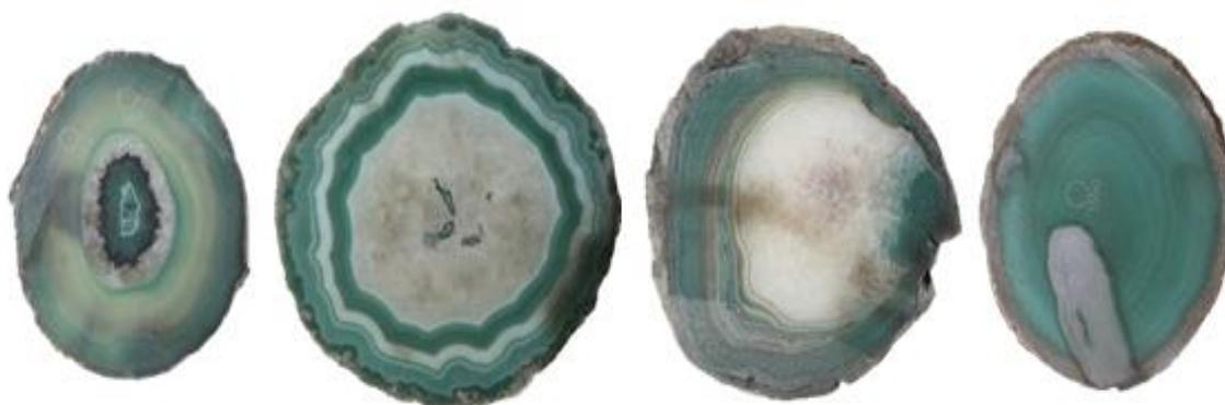
**Figura 93.** Amostras de lâminas de ágata com numeração 15, da categoria “vidrada” (15V1 e 15V2), seguida da categoria “bandada” (15B1 e 15B2), “sal” (15S1e 15S2) e “massa” (15M1 e 15M2), da esquerda para a direita. Amostras após o tingimento, submetidas à pigmentação artificial em verde, na concentração 2.
