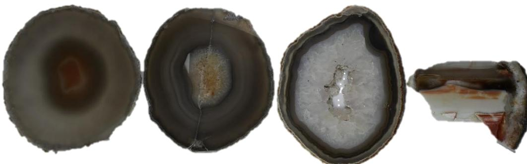
**Figura 70.** Amostras de lâminas de ágata com numeração 2, da categoria “vidrada” (2V1 e 2V2), seguida da categoria “bandada” (2B1 e 2B2), “sal” (2S1e 2S2) e “massa” (2M1 e 2M2), da esquerda para a direita. Amostras após o polimento, submetidas à pigmentação artificial em vermelho em sistema comercial local.
