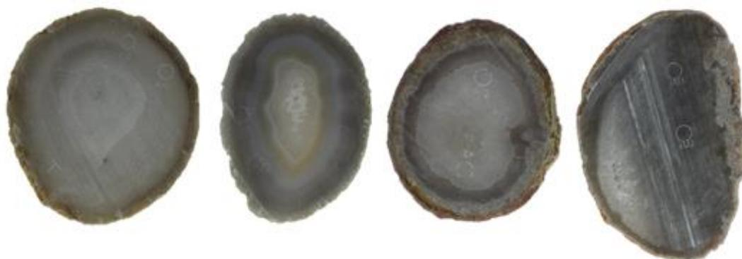
**Figura 98.** Amostras de lâminas de ágata com numeração 4, da categoria “vidrada” (4V1 e 4V2), seguida da categoria “bandada” (4B1 e 4B2), “sal” (4S1e 4S2) e “massa” (4M1 e 4M2), da esquerda para a direita. Amostras antes do tingimento em verde.
