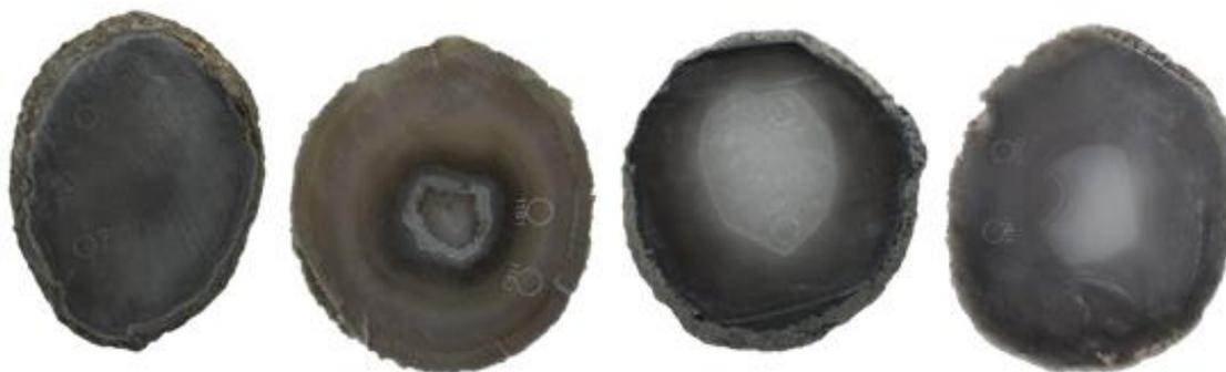
**Figura 74.** Amostras de lâminas de ágata com numeração 11, da categoria “vidrada” (11V1 e 11V2), seguida da categoria “bandada” (11B1 e 11B2), “sal” (11S1e 11S2) e “massa” (11M1 e 11M2), da esquerda para a direita. Amostras antes do tingimento em azul, para a concentração 1.
