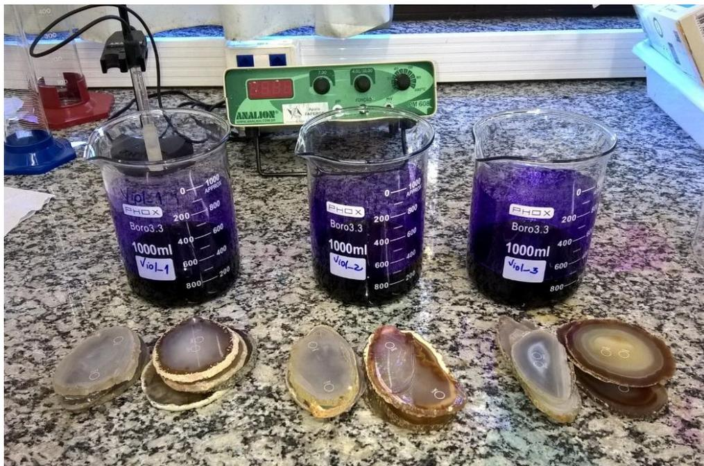
**Figura 42.** Vista dos lotes de ágata submetidos ao tingimento otimizado em roxo, a partir do corante cristal violeta, para as concentrações 1, 2 e 3.
