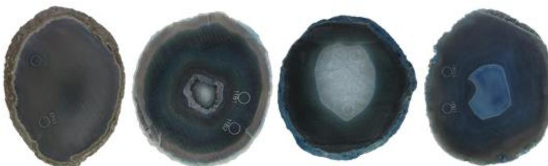
**Figura 75.** Amostras de lâminas de ágata com numeração 11, da categoria “vidrada” (11V1 e 11V2), seguida da categoria “bandada” (11B1 e 11B2), “sal” (11S1e 11S2) e “massa” (11M1 e 11M2), da esquerda para a direita. Amostras após o tingimento, submetidas à pigmentação artificial em azul, na concentração 1.
