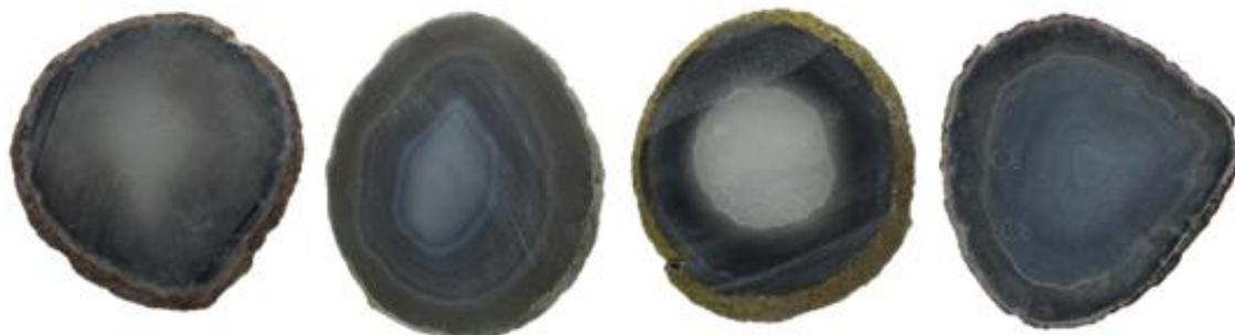
**Figura 77.** Amostras de lâminas de ágata com numeração 12, da categoria “vidrada” (12V1 e 12V2), seguida da categoria “bandada” (12B1 e 12B2), “sal” (12S1e 12S2) e “massa” (12M1 e 12M2), da esquerda para a direita. Amostras antes do tingimento em azul, para a concentração 2.
