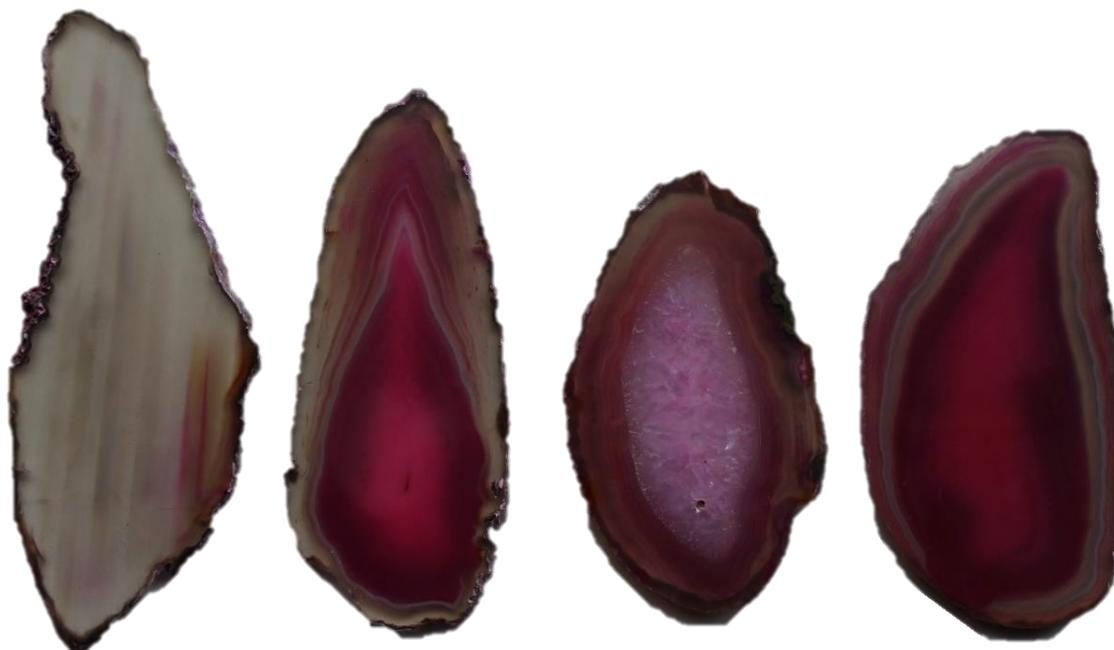
**Figura 121.** Amostras de lâminas de ágata com numeração 114, da categoria “vidrada” (114V1 e 114V2), seguida da categoria “bandada” (114B1 e 114B2), “sal” (114S1e 114S2) e “massa” (114M1 e 114M2), da esquerda para a direita. Amostras submetidas ao tingimento convencional em rosa, a base de corante orgânico, após polimento.
