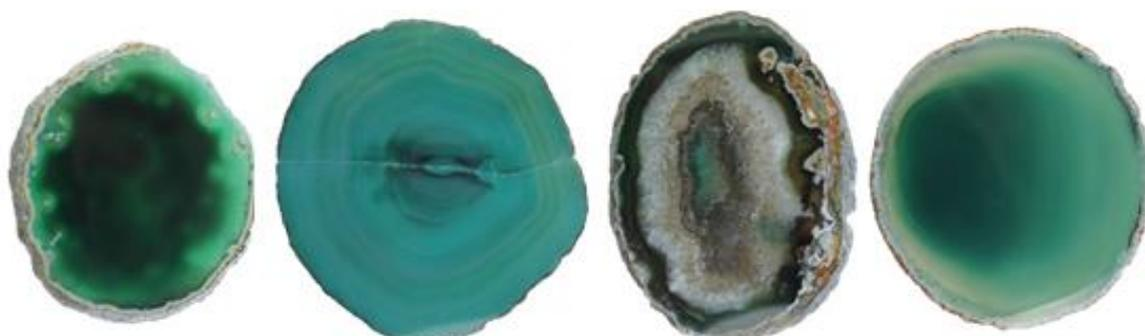
**Figura 97.** Amostras de lâminas de ágata com numeração 16, da categoria “vidrada” (16V1 e 16V2), seguida da categoria “bandada” (16B1 e 16B2), “sal” (16S1 e 16S2) e “massa” (16M1 e 16M2), da esquerda para a direita. Amostras após o polimento, submetidas à pigmentação artificial em verde, na concentração 3.
