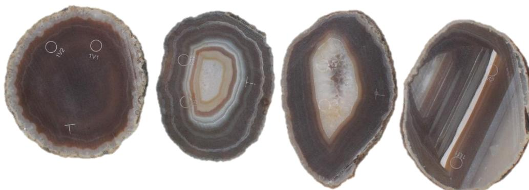
**Figura 54.** Amostras de lâminas de ágata com numeração 1, da categoria “vidrada” (1V1 e 1V2), seguida da categoria “bandada” (1B1 e 1B2), “sal” (1S1e 1S2) e “massa” (1M1 e 1M2), da esquerda para a direita. Amostras após o tingimento, submetidas à pigmentação artificial convencional em preto.
