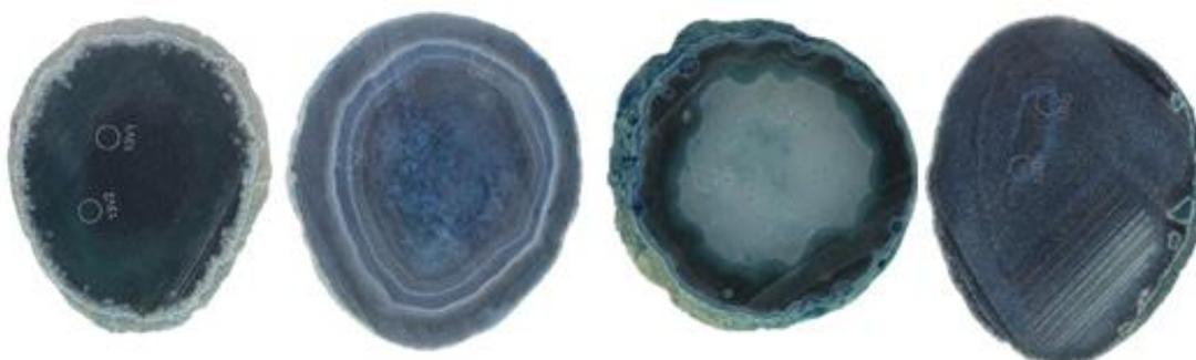
**Figura 81.** Amostras de lâminas de ágata com numeração 13, da categoria “vidrada” (13V1 e 13V2), seguida da categoria “bandada” (13B1 e 13B2), “sal” (13S1e 13S2) e “massa” (13M1 e 13M2), da esquerda para a direita. Amostras após o tingimento, submetidas à pigmentação artificial em azul, na concentração 3.
