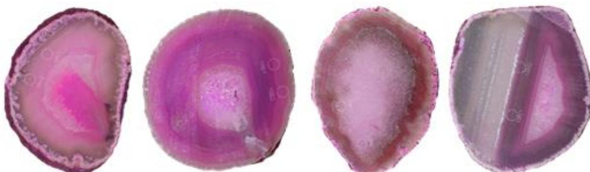
**Figura 111.** Amostras de lâminas de ágata com numeração 19, da categoria “vidrada” (19V1 e 19V2), seguida da categoria “bandada” (19B1 e 19B2), “sal” (19S1e 19S2) e “massa” (19M1 e 19M2), da esquerda para a direita. Amostras submetidas ao tingimento em rosa orgânico, para a concentração 3, após tingimento das peças.
