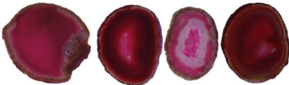
**Figura 115.** Amostras de lâminas de ágata com numeração 5, da categoria “vidrada” (5V1 e 5V2), seguida da categoria “bandada” (5B1 e 5B2), “sal” (5S1e 5S2) e “massa” (5M1 e 5M2), da esquerda para a direita. Amostras submetidas ao tingimento em rosa orgânico, para a concentração 4, após polimento das peças.
