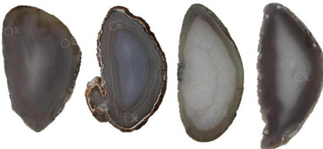
**Figura 47.** Amostras de lâminas de ágata com numeração 2, da categoria “vidrada” (2V1 e 2V2), seguida da categoria “bandada” (2B1 e 2B2), “sal” (2S1e 2S2) e “massa” (2M1 e 2M2), da esquerda para a direita. Amostras antes do tingimento, para a concentração 2.
