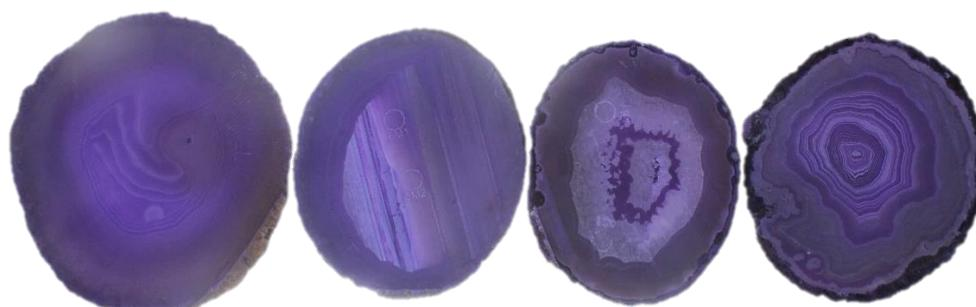
**Figura 152.** Amostras de lâminas de ágata com numeração 06, da categoria “vidrada” (06V1 e 06V2), seguida da categoria “bandada” (06B1 e 06B2), “sal” (06S1e 06S2) e “massa” (06M1 e 06M2), da esquerda para a direita. Amostras após tingimento em violeta, a partir de corantes orgânicos comerciais, na concentração 4.
