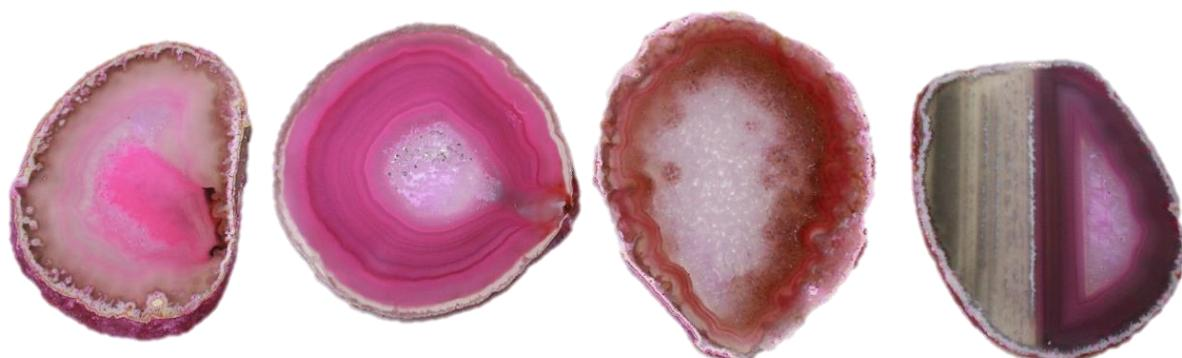
**Figura 112.** Amostras de lâminas de ágata com numeração 19, da categoria “vidrada” (19V1 e 19V2), seguida da categoria “bandada” (19B1 e 19B2), “sal” (19S1e 19S2) e “massa” (19M1 e 19M2), da esquerda para a direita. Amostras submetidas ao tingimento em rosa orgânico, para a concentração 3, após polimento das peças.
