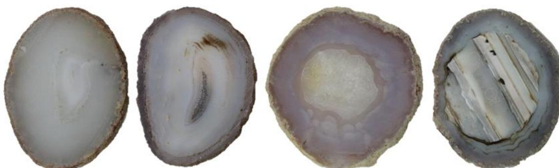
**Figura 60.** Amostras de lâminas de ágata com numeração 9, da categoria “vidrada” (9V1 e 9V2), seguida da categoria “bandada” (9B1 e 9B2), “sal” (9S1e 9S2) e “massa” (9M1 e 9M2), da esquerda para a direita. Amostras após o tingimento, submetidas à pigmentação artificial em vermelho, na concentração 1.
