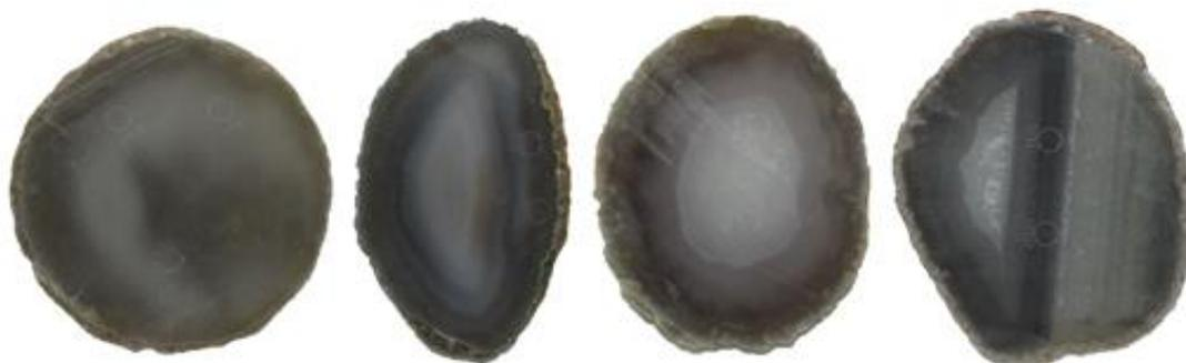
**Figura 104.** Amostras de lâminas de ágata com numeração 17, da categoria “vidrada” (17V1 e 17V2), seguida da categoria “bandada” (17B1 e 17B2), “sal” (17S1e 17S2) e “massa” (17M1 e 17M2), da esquerda para a direita. Amostras antes do tingimento em rosa orgânico, para a concentração 1.
