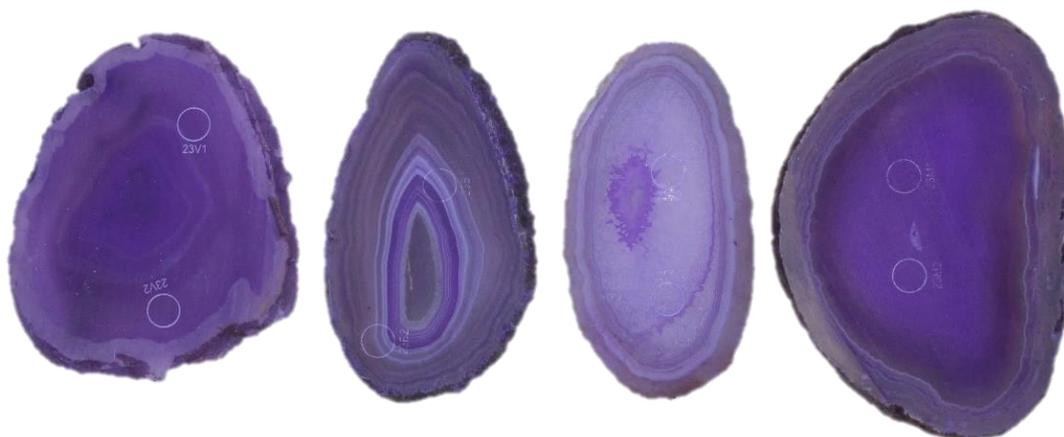
**Figura 144.** Amostras de lâminas de ágata com numeração 23, da categoria “vidrada” (23V1 e 23V2), seguida da categoria “bandada” (23B1 e 23B2), “sal” (23S1e 23S2) e “massa” (23M1 e 23M2), da esquerda para a direita. Amostras após tingimento em violeta, a partir de corante orgânico, na concentração 1.
