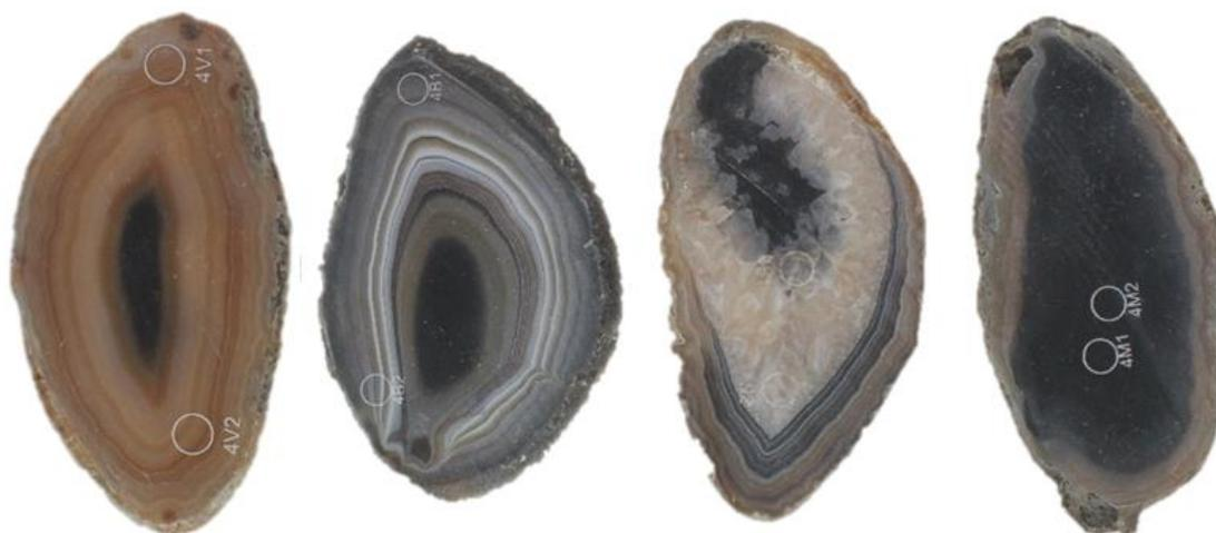
**Figura 51.** Amostras de lâminas de ágata com numeração 4, da categoria “vidrada” (4V1 e 4V2), seguida da categoria “bandada” (4B1 e 4B2), “sal” (4S1e 4S2) e “massa” (4M1 e 4M2), da esquerda para a direita. Amostras após o tingimento, submetidas à pigmentação artificial em preto, na concentração 3.
