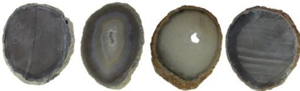
**Figura 132.** Amostras de lâminas de ágata com numeração 7, da categoria “vidrada” (7V1 e 7V2), seguida da categoria “bandada” (7B1 e 7B2), “sal” (7S1e 7S2) e “massa” (7M1 e 7M2), da esquerda para a direita. Amostras submetidas ao tingimento em verde orgânico, para a concentração 4, antes do tingimento.
