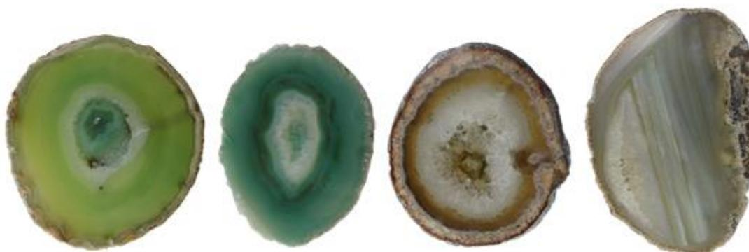
**Figura 100.** Amostras de lâminas de ágata com numeração 4, da categoria “vidrada” (4V1 e 4V2), seguida da categoria “bandada” (4B1 e 4B2), “sal” (4S1e 4S2) e “massa” (4M1 e 4M2), da esquerda para a direita. Amostras após o polimento, submetidas à pigmentação artificial em verde em sistema comercial local.
