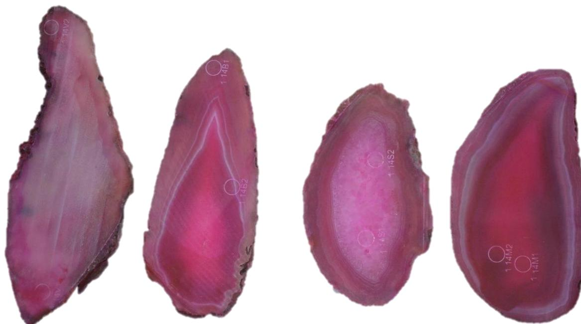
**Figura 120** Amostras de lâminas de ágata com numeração 114, da categoria “vidrada” (114V1 e 114V2), seguida da categoria “bandada” (114B1 e 114B2), “sal” (114S1e 114S2) e “massa” (114M1 e 114M2), da esquerda para a direita. Amostras após tingimento convencional em rosa, a base de corante orgânico.
