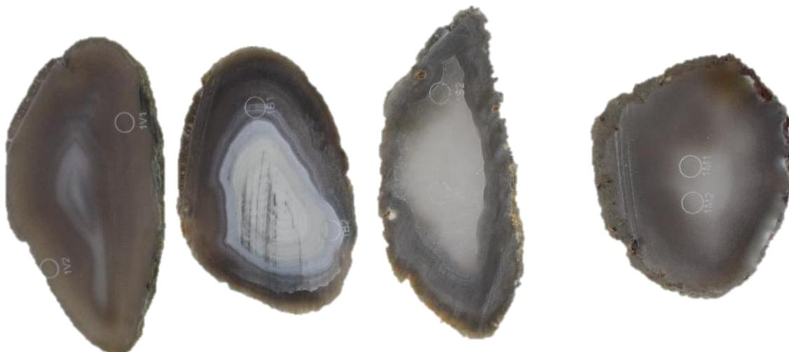
Figura 44. Amostras de lâminas de ágata com numeração 1, da categoria “vidrada” (1V1 e 1V2), seguida da categoria “bandada” (1B1 e 1B2), “sal” (1S1e 1S2) e “massa” (1M1 e 1M2), da esquerda para a direita. Amostras antes do tingimento preto, para a concentração 1.
