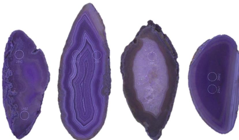
**Figura 149.** Amostras de lâminas de ágata com numeração 25, da categoria “vidrada” (25V1 e 25V2), seguida da categoria “bandada” (25B1 e 25B2), “sal” (25S1e 25S2) e “massa” (25M1 e 25M2), da esquerda para a direita. Amostras após tingimento em violeta, a partir de corante orgânico, na concentração 3.
