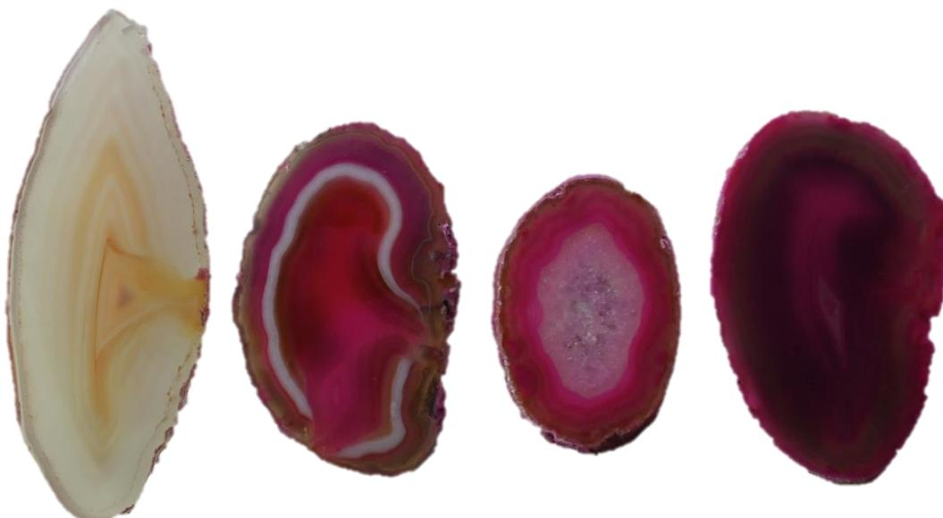
**Figura 118.** Amostras de lâminas de ágata com numeração 110, da categoria “vidrada” (110V1 e 110V2), seguida da categoria “bandada” (110B1 e 110B2), “sal” (110S1e 110S2) e “massa” (110M1 e 110M2), da esquerda para a direita. Amostras submetidas ao tingimento em rosa orgânico, para a concentração 5, após polimento das peças.
