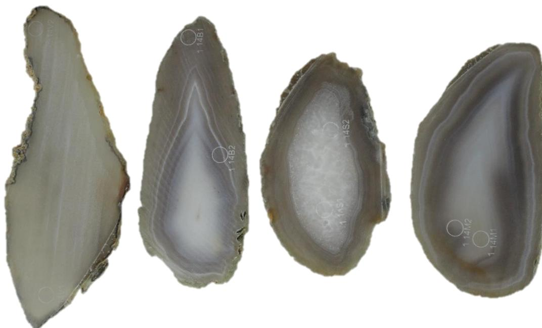
**Figura 119.** Amostras de lâminas de ágata com numeração 114, da categoria “vidrada” (114V1 e 114V2), seguida da categoria “bandada” (114B1 e 114B2), “sal” (114S1e 114S2) e “massa” (114M1 e 114M2), da esquerda para a direita. Amostras antes do tingimento convencional em rosa, a base de corante orgânico.
