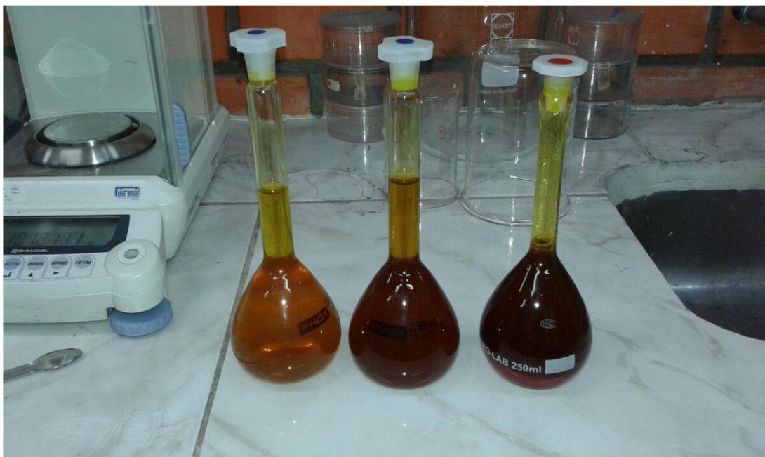
Figura 33. Soluções de ferricianeto de potássio, em três concentrações diferentes.
