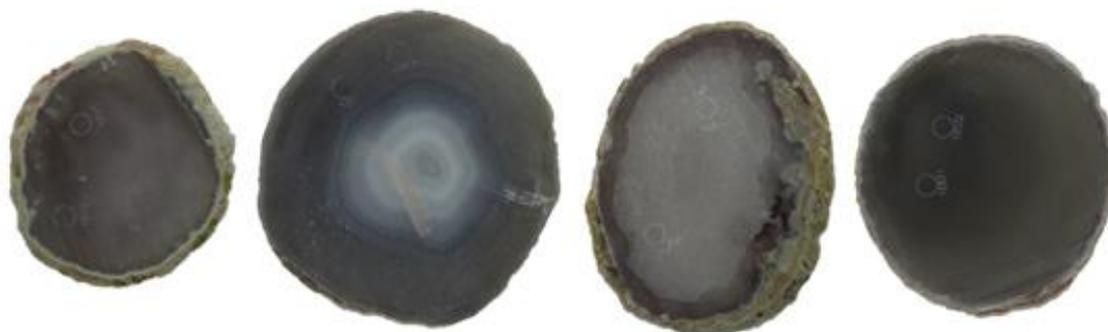
**Figura 95.** Amostras de lâminas de ágata com numeração 16, da categoria “vidrada” (16V1 e 16V2), seguida da categoria “bandada” (16B1 e 16B2), “sal” (16S1e 16S2) e “massa” (16M1 e 16M2), da esquerda para a direita. Amostras antes do tingimento em verde, para a concentração 3.
