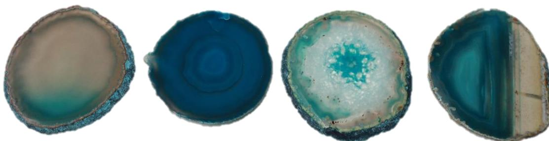
**Figura 127.** Amostras de lâminas de ágata com numeração 20, da categoria “vidrada” (20V1 e 20V2), seguida da categoria “bandada” (20B1 e 20B2), “sal” (20S1e 20S2) e “massa” (20M1 e 20M2), da esquerda para a direita. Amostras submetidas ao tingimento em verde orgânico, para a concentração 1, após polimento das peças.
