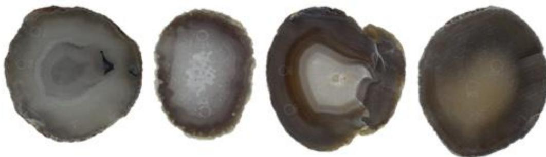
**Figura 83.** Amostras de lâminas de ágata com numeração 3, da categoria “vidrada” (3V1 e 3V2), seguida da categoria “bandada” (3B1 e 3B2), “sal” (3S1e 3S2) e “massa” (3M1 e 3M2), da esquerda para a direita. Amostras antes do tingimento azul convencional.
