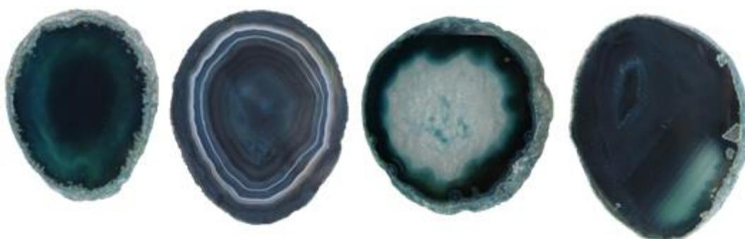
**Figura 82.** Amostras de lâminas de ágata com numeração 13, da categoria “vidrada” (13V1 e 13V2), seguida da categoria “bandada” (13B1 e 13B2), “sal” (13S1 e 13S2) e “massa” (13M1 e 13M2), da esquerda para a direita. Amostras após o polimento, submetidas à pigmentação artificial em azul, na concentração 3.
