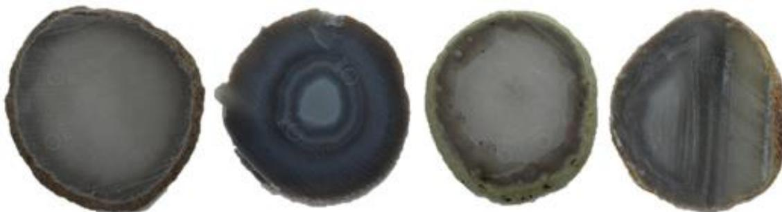
**Figura 125.** Amostras de lâminas de ágata com numeração 20, da categoria “vidrada” (20V1 e 20V2), seguida da categoria “bandada” (20B1 e 20B2), “sal” (20S1e 20S2) e “massa” (20M1 e 20M2), da esquerda para a direita. Amostras submetidas ao tingimento em verde orgânico, para a concentração 1, antes do tingimento.
