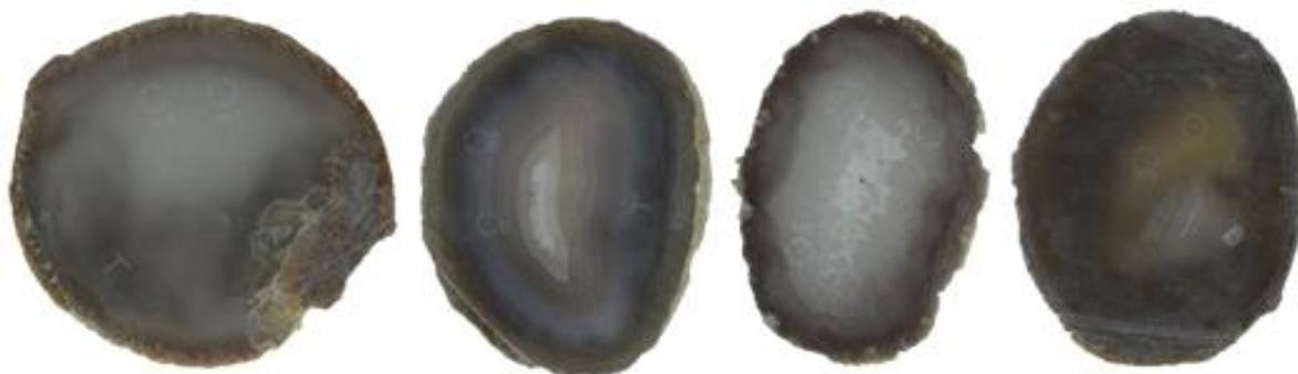
**Figura 113.** Amostras de lâminas de ágata com numeração 5, da categoria “vidrada” (5V1 e 5V2), seguida da categoria “bandada” (5B1 e 5B2), “sal” (5S1e 5S2) e “massa” (5M1 e 5M2), da esquerda para a direita. Amostras submetidas ao tingimento em rosa orgânico, para a concentração 4, antes do tingimento.
