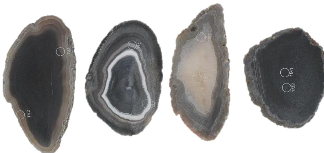
Figura 45. Amostras de lâminas de ágata com numeração 1, da categoria “vidrada” (1V1 e 1V2), seguida da categoria “bandada” (1B1 e 1B2), “sal” (1S1e 1S2) e “massa” (1M1 e 1M2), da esquerda para a direita. Amostras após o tingimento, submetidas à pigmentação artificial em preto, na concentração 1.
