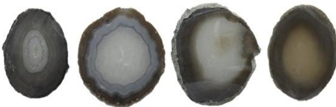
**Figura 92.** Amostras de lâminas de ágata com numeração 15, da categoria “vidrada” (15V1 e 15V2), seguida da categoria “bandada” (15B1 e 15B2), “sal” (15S1e 15S2) e “massa” (15M1 e 15M2), da esquerda para a direita. Amostras antes do tingimento em verde, para a concentração 2.
