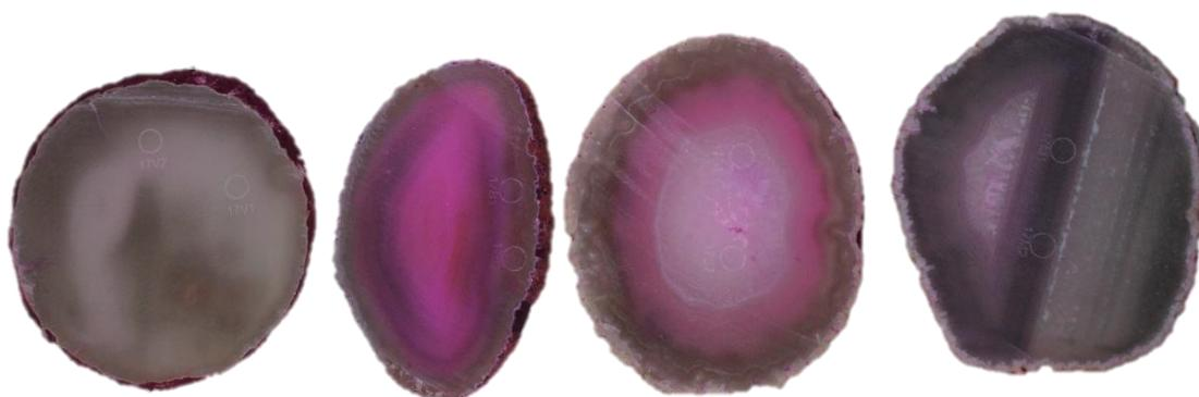
**Figura 105.** Amostras de lâminas de ágata com numeração 17, da categoria “vidrada” (17V1 e 17V2), seguida da categoria “bandada” (17B1 e 17B2), “sal” (17S1e 17S2) e “massa” (17M1 e 17M2), da esquerda para a direita. Amostras após tingimento em rosa orgânico, para a concentração 1.
