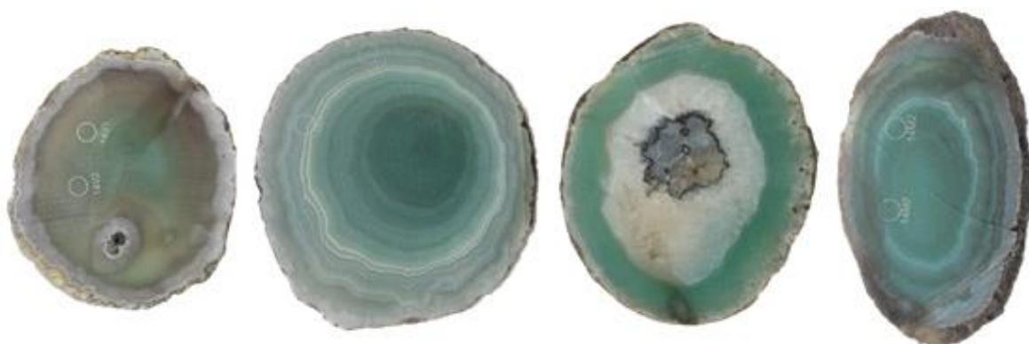
**Figura 90.** Amostras de lâminas de ágata com numeração 14, da categoria “vidrada” (14V1 e 14V2), seguida da categoria “bandada” (14B1 e 14B2), “sal” (14S1e 14S2) e “massa” (14M1 e 14M2), da esquerda para a direita. Amostras após o tingimento, submetidas à pigmentação artificial em verde, na concentração 1.
