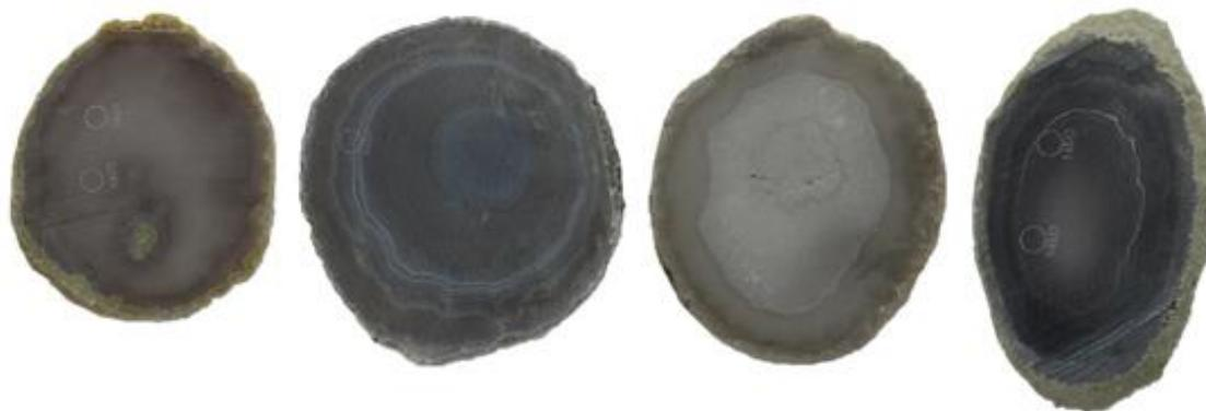
**Figura 89.** Amostras de lâminas de ágata com numeração 14, da categoria “vidrada” (14V1 e 14V2), seguida da categoria “bandada” (14B1 e 14B2), “sal” (14S1e 14S2) e “massa” (14M1 e 14M2), da esquerda para a direita. Amostras antes do tingimento em verde, para a concentração 1.
