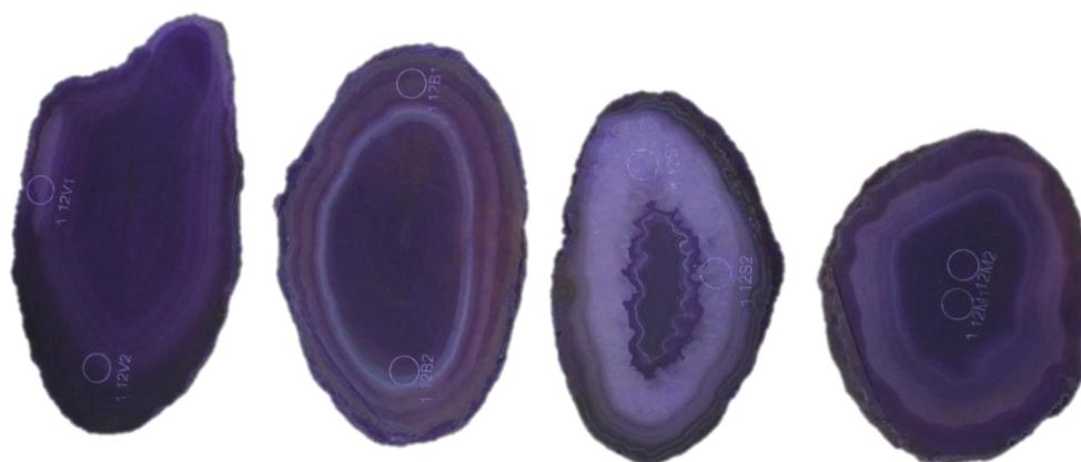
Figura 155. Amostras de lâminas de ágata com numeração 112, da categoria “vidrada” (112V1 e 112V2), seguida da categoria “bandada” (112B1 e 112B2), “sal” (112S1e 112S2) e “massa” (112M1 e 112M2), da esquerda para a direita. Amostras após tingimento em violeta, a partir de corante orgânico, na concentração 5.
