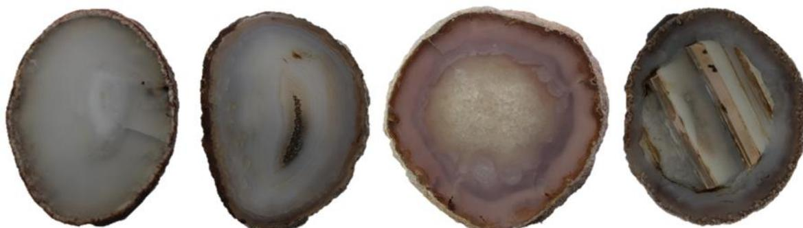
**Figura 61.** Amostras de lâminas de ágata com numeração 9, da categoria “vidrada” (9V1 e 9V2), seguida da categoria “bandada” (9B1 e 9B2), “sal” (9S1e 9S2) e “massa” (9M1 e 9M2), da esquerda para a direita. Amostras após o polimento, submetidas à pigmentação artificial em vermelho, na concentração 1.
