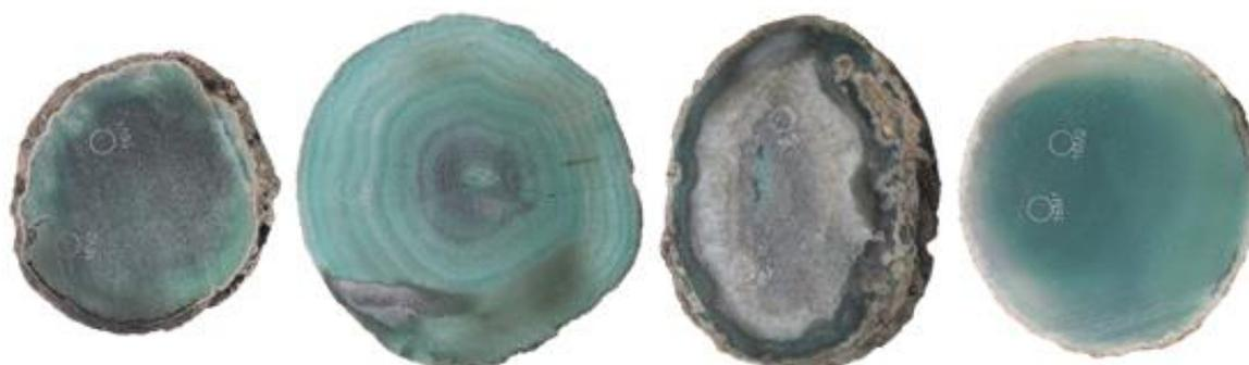
**Figura 96.** Amostras de lâminas de ágata com numeração 16, da categoria “vidrada” (16V1 e 16V2), seguida da categoria “bandada” (16B1 e 16B2), “sal” (16S1e 16S2) e “massa” (16M1 e 16M2), da esquerda para a direita. Amostras após o tingimento, submetidas à pigmentação artificial em verde, na concentração 3.
