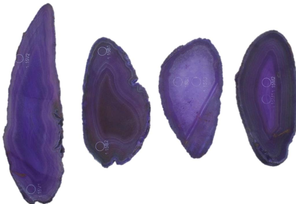
**Figura 158.** Amostras de lâminas de ágata com numeração 115, da categoria “vidrada” (115V1 e 115V2), seguida da categoria “bandada” (115B1 e 115B2), “sal” (115S1 e 115S2) e “massa” (115M1 e 115M2), da esquerda para a direita. Amostras após tingimento das peças submetidas à coloração convencional em roxo.
