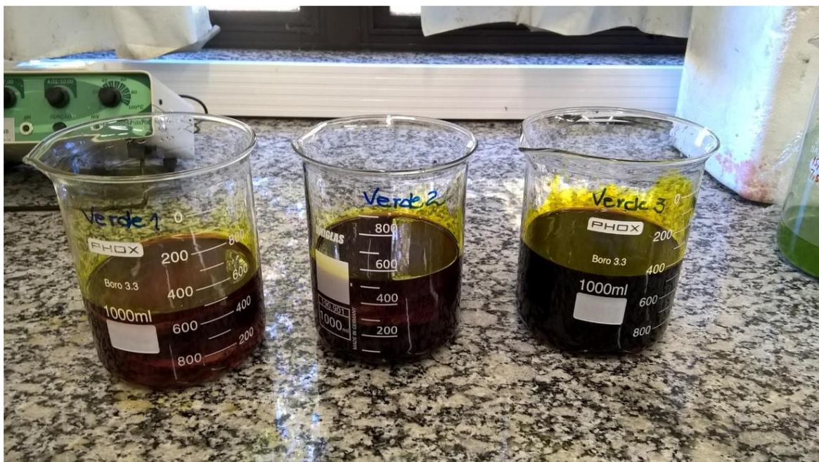
**Figura 36.** Vista geral dos lotes de ágatas submetidos ao tingimento otimizado em solução aquosa para obtenção da cor verde, nas concentrações 1, 2 e 3, da esquerda para a direita.
