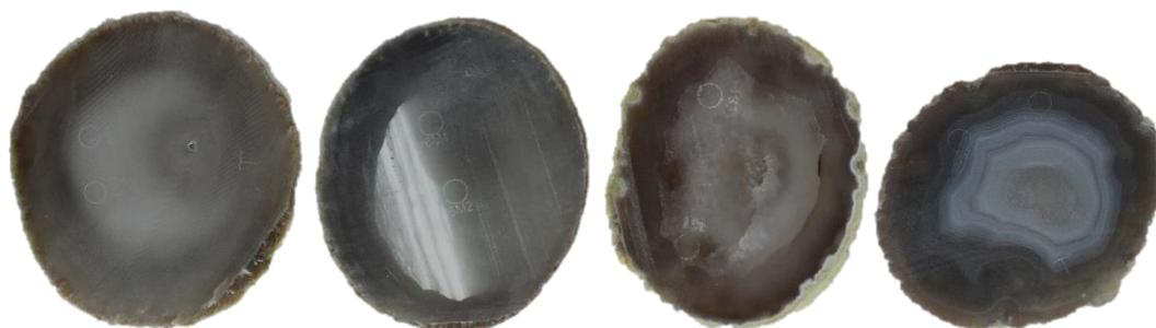
**Figura 151.** Amostras de lâminas de ágata com numeração 06, da categoria “vidrada” (06V1 e 06V2), seguida da categoria “bandada” (06B1 e 06B2), “sal” (06S1e 06S2) e “massa” (06M1 e 06M2), da esquerda para a direita. Amostras anterior ao tingimento em violeta, a partir de corantes orgânicos comerciais, na concentração 4.
