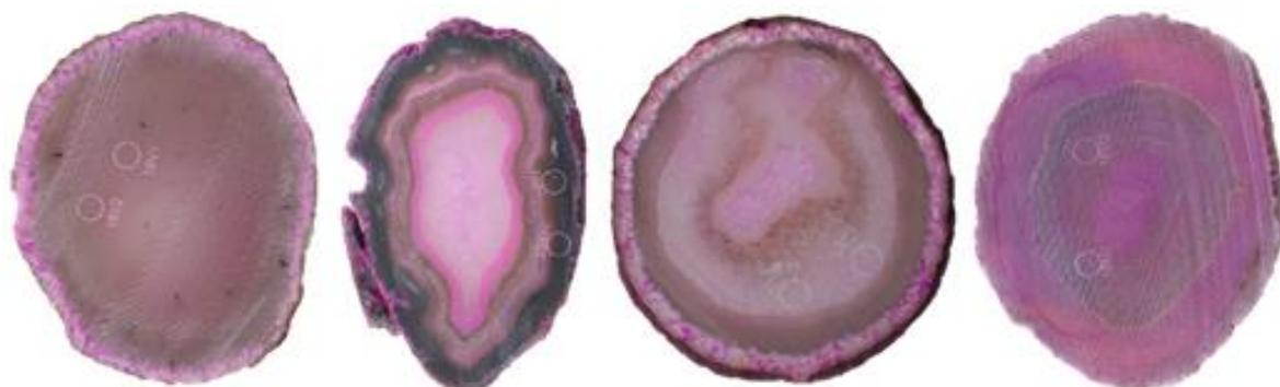
Figura 108. Amostras de lâminas de ágata com numeração 18, da categoria “vidrada” (18V1 e 18V2), seguida da categoria “bandada” (18B1 e 18B2), “sal” (18S1e 18S2) e “massa” (18M1 e 18M2), da esquerda para a direita. Amostras após tingimento em rosa orgânico, para a concentração 2.
