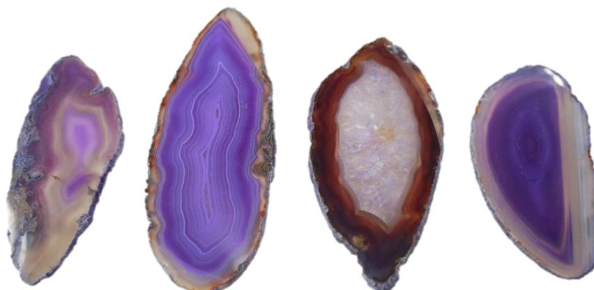
**Figura 150.** Amostras de lâminas de ágata com numeração 25, da categoria “vidrada” (25V1 e 25V2), seguida da categoria “bandada” (25B1 e 25B2), “sal” (25S1e 25S2) e “massa” (25M1 e 25M2), da esquerda para a direita. Amostras após polimento das amostras submetidas ao tingimento em violeta, a partir de corante orgânico, na concentração 3.
