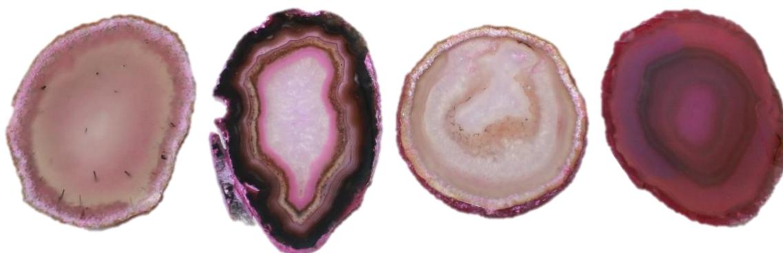
Figura 109. Amostras de lâminas de ágata com numeração 18, da categoria “vidrada” (18V1 e 18V2), seguida da categoria “bandada” (18B1 e 18B2), “sal” (18S1e 18S2) e “massa” (18M1 e 18M2), da esquerda para a direita. Amostras submetidas ao tingimento em rosa orgânico, para a concentração 2, após polimento das peças.
