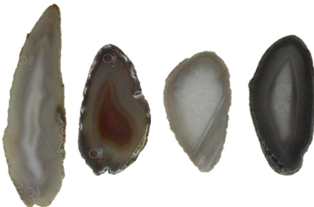
**Figura 157. Amostras de lâminas de ágata com numeração 115, da categoria “vidrada” (115V1 e 115V2), seguida da categoria “bandada” (115B1 e 115B2), “sal” (115S1e 115S2) e “massa” (115M1 e 115M2), da esquerda para a direita. Amostras antes do tingimento das peças submetidas ao tingimento convencional em roxo.**
