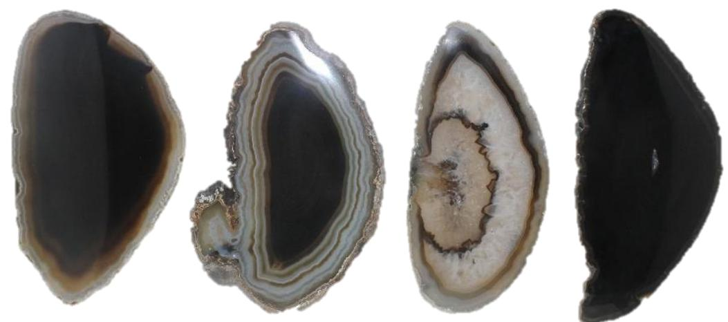
**Figura 49.** Amostras de lâminas de ágata com numeração 2, da categoria “vidrada” (2V1 e 2V2), seguida da categoria “bandada” (2B1 e 2B2), “sal” (2S1e 2S2) e “massa” (2M1 e 2M2), da esquerda para a direita. Amostras após o polimento, submetidas à pigmentação artificial em preto, na concentração 2.
