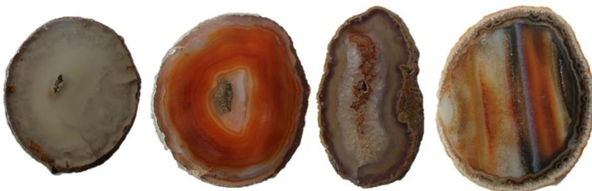
**Figura 64.** Amostras de lâminas de ágata com numeração 10, da categoria “vidrada” (10V1 e 10V2), seguida da categoria “bandada” (10B1 e 10B2), “sal” (10S1e 10S2) e “massa” (10M1 e 10M2), da esquerda para a direita. Amostras após o polimento, submetidas à pigmentação artificial em vermelho, na concentração 2.
