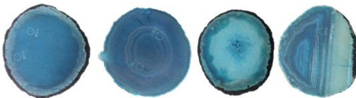
**Figura 126.** Amostras de lâminas de ágata com numeração 20, da categoria “vidrada” (20V1 e 20V2), seguida da categoria “bandada” (20B1 e 20B2), “sal” (20S1e 20S2) e “massa” (20M1 e 20M2), da esquerda para a direita. Amostras submetidas ao tingimento em verde orgânico, para a concentração 1, após tingimento das peças.
