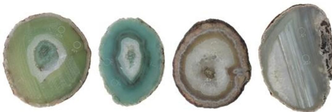
**Figura 99.** Amostras de lâminas de ágata com numeração 4, da categoria “vidrada” (4V1 e 4V2), seguida da categoria “bandada” (4B1 e 4B2), “sal” (4S1e 4S2) e “massa” (4M1 e 4M2), da esquerda para a direita. Amostras após o tingimento, submetidas à pigmentação artificial em verde em sistema comercial local.
