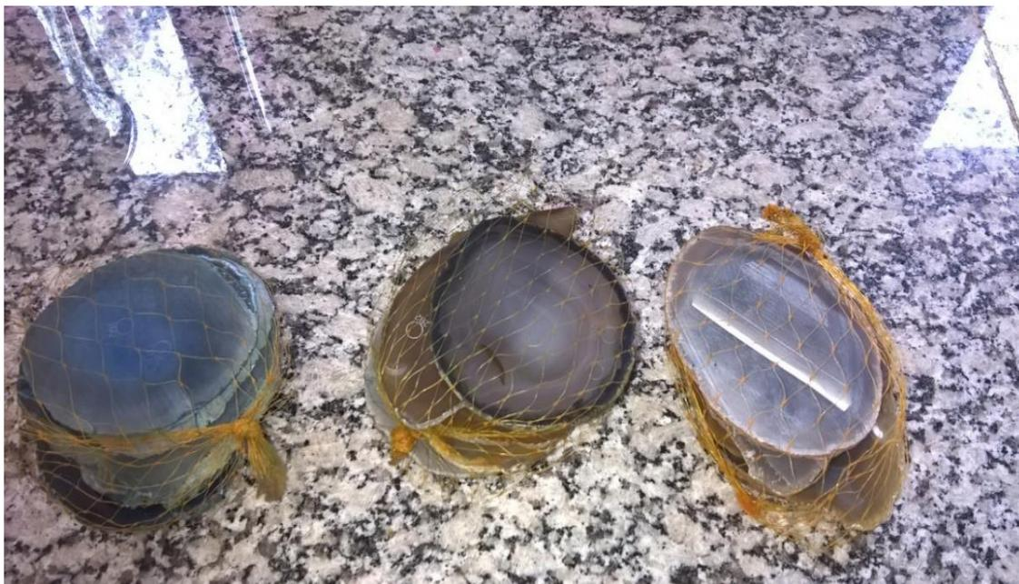
Figura 24. Classificação em grupos de ágatas, com 4 amostras diferentes para recebimento de coloração artificial. Cada conjunto contém uma amostra de água da categoria vidrada, bandada, de sal e de massa.
