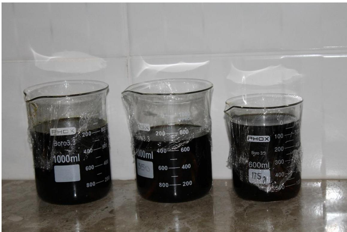
Figura 28. Etapa de imersão de ágatas em solução de açúcar nas concentrações I, II e III, durante o processo de otimização da coloração artificial preta.
