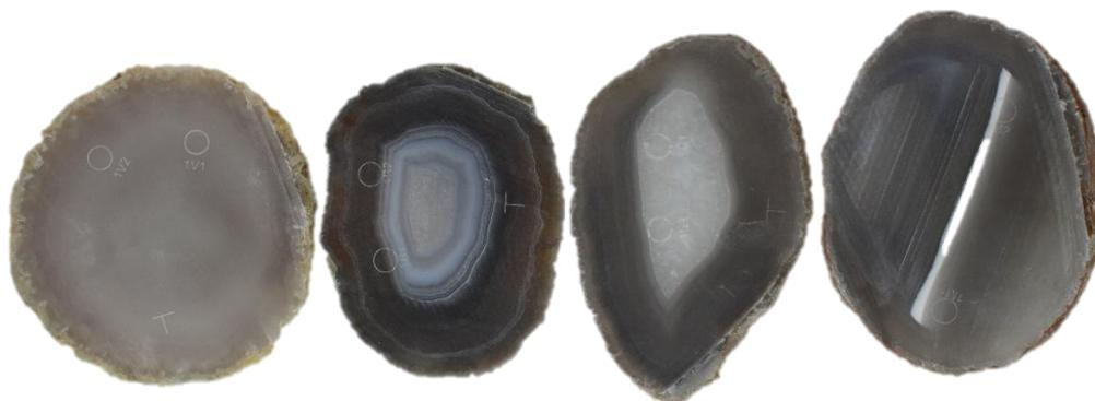
**Figura 53.** Amostras de lâminas de ágata com numeração 1, da categoria “vidrada” (1V1 e 1V2), seguida da categoria “bandada” (1B1 e 1B2), “sal” (1S1e 1S2) e “massa” (1M1 e 1M2), da esquerda para a direita. Amostras antes do tingimento convencional em preto.
