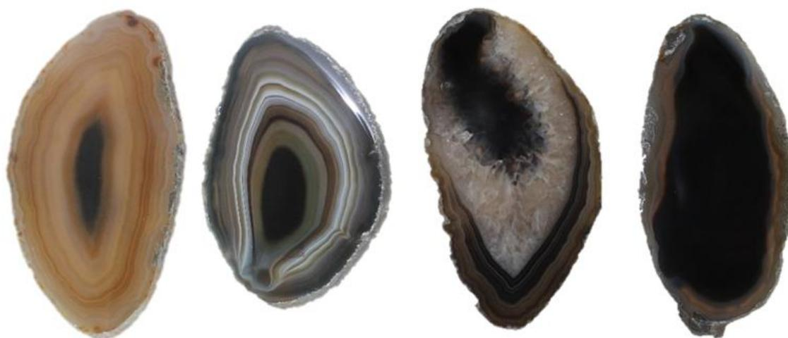
**Figura 52.** Amostras de lâminas de ágata com numeração 4, da categoria “vidrada” (4V1 e 4V2), seguida da categoria “bandada” (4B1 e 4B2), “sal” (4S1e 4S2) e “massa” (4M1 e 4M2), da esquerda para a direita. Amostras após o polimento, submetidas à pigmentação artificial em preto, na concentração 3.
