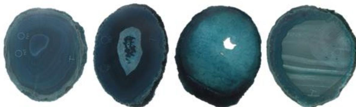
**Figura 133.** Amostras de lâminas de ágata com numeração 7, da categoria “vidrada” (7V1 e 7V2), seguida da categoria “bandada” (7B1 e 7B2), “sal” (7S1e 7S2) e “massa” (7M1 e 7M2), da esquerda para a direita. Amostras submetidas ao tingimento em verde orgânico, para a concentração 4, após tingimento das peças.
