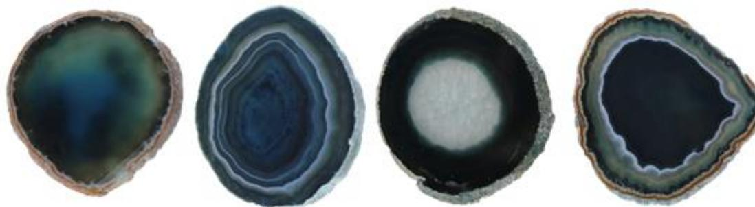
**Figura 79.** Amostras de lâminas de ágata com numeração 12, da categoria “vidrada” (12V1 e 12V2), seguida da categoria “bandada” (12B1 e 12B2), “sal” (12S1e 12S2) e “massa” (12M1 e 12M2), da esquerda para a direita. Amostras após o polimento, submetidas à pigmentação artificial em azul, na concentração 2.
