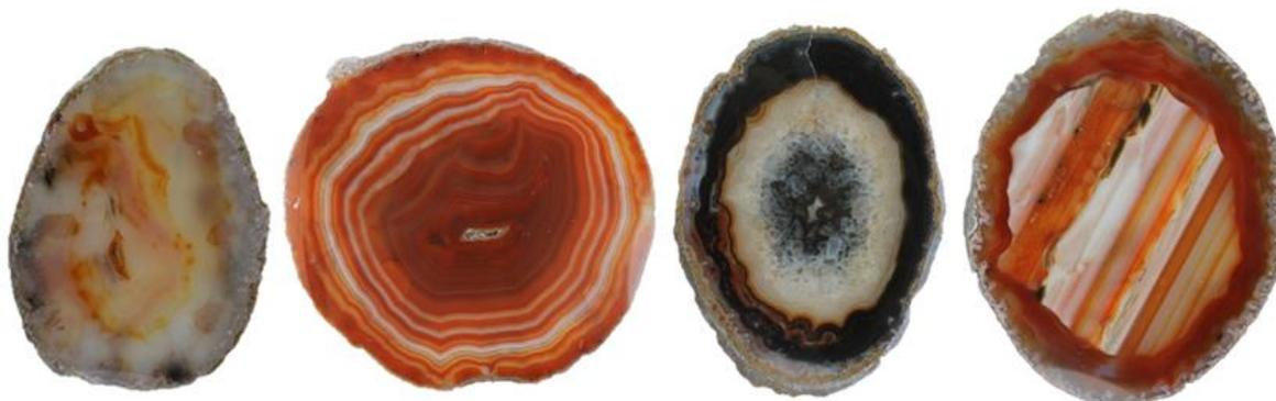
**Figura 67.** Amostras de lâminas de ágata com numeração 8, da categoria “vidrada” (8V1 e 8V2), seguida da categoria “bandada” (8B1 e 8B2), “sal” (8S1e 8S2) e “massa” (8M1 e 8M2), da esquerda para a direita. Amostras após o polimento, submetidas à pigmentação artificial em vermelho, na concentração 3.
