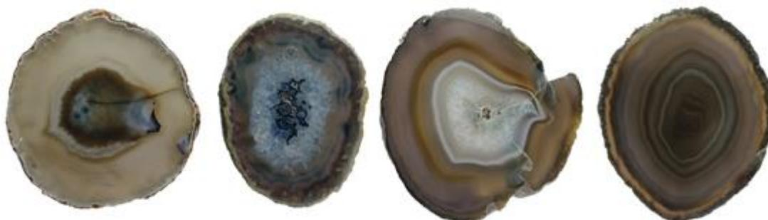
**Figura 85.** Amostras de lâminas de ágata com numeração 3, da categoria “vidrada” (3V1 e 3V2), seguida da categoria “bandada” (3B1 e 3B2), “sal” (3S1e 3S2) e “massa” (3M1 e 3M2), da esquerda para a direita. Amostras após o polimento, submetidas à pigmentação artificial em azul convencional.
