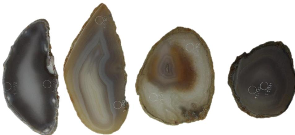
**Figura 135.** Amostras de lâminas de ágata com numeração 111, da categoria “vidrada” (111V1 e 111V2), seguida da categoria “bandada” (111B1 e 111B2), “sal” (111S1e 111S2) e “massa” (111M1 e 111M2), da esquerda para a direita. Amostras submetidas ao tingimento em verde orgânico, para a concentração 5, antes do tingimento das peças.
