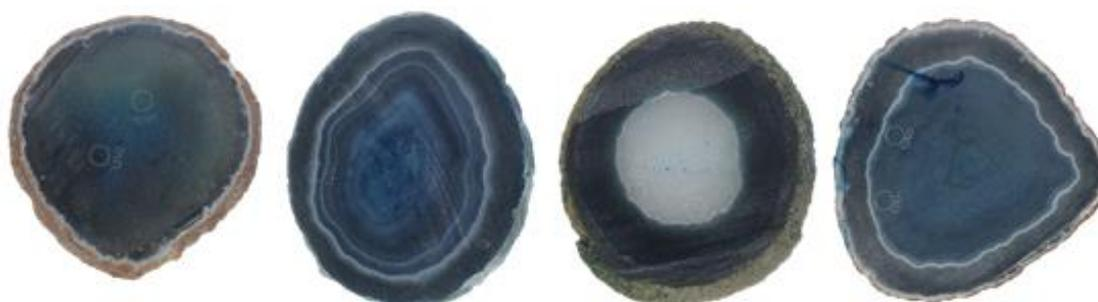
**Figura 78.** Amostras de lâminas de ágata com numeração 12, da categoria “vidrada” (12V1 e 12V2), seguida da categoria “bandada” (12B1 e 12B2), “sal” (12S1e 12S2) e “massa” (12M1 e 12M2), da esquerda para a direita. Amostras após o tingimento, submetidas à pigmentação artificial em azul, na concentração 2.
