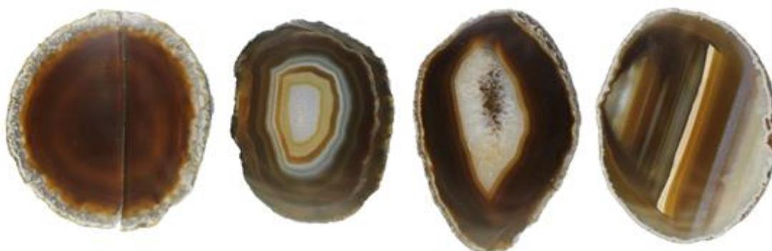
**Figura 55.** Amostras de lâminas de ágata com numeração 1, da categoria “vidrada” (1V1 e 1V2), seguida da categoria “bandada” (1B1 e 1B2), “sal” (1S1e 1S2) e “massa” (1M1 e 1M2), da esquerda para a direita. Amostras após o polimento, submetidas à pigmentação artificial convencional em preto.
