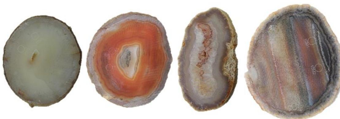
**Figura 63.** Amostras de lâminas de ágata com numeração 10, da categoria “vidrada” (10V1 e 10V2), seguida da categoria “bandada” (10B1 e 10B2), “sal” (10S1e 10S2) e “massa” (10M1 e 10M2), da esquerda para a direita. Amostras após o tingimento, submetidas à pigmentação artificial em vermelho, na concentração 2.
