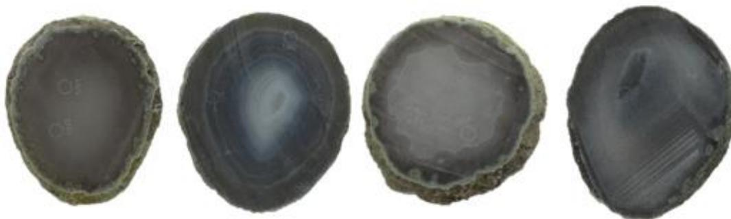
**Figura 80.** Amostras de lâminas de ágata com numeração 13, da categoria “vidrada” (13V1 e 13V2), seguida da categoria “bandada” (13B1 e 13B2), “sal” (13S1e 13S2) e “massa” (13M1 e 13M2), da esquerda para a direita. Amostras antes do tingimento em azul, para a concentração 3.
