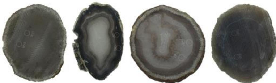
Figura 107. Amostras de lâminas de ágata com numeração 18, da categoria “vidrada” (18V1 e 18V2), seguida da categoria “bandada” (18B1 e 18B2), “sal” (18S1e 18S2) e “massa” (18M1 e 18M2), da esquerda para a direita. Amostras antes do tingimento em rosa orgânico, para a concentração 2.
