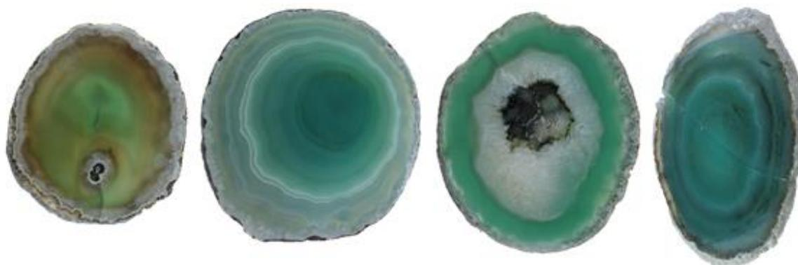
**Figura 91.** Amostras de lâminas de ágata com numeração 14, da categoria “vidrada” (14V1 e 14V2), seguida da categoria “bandada” (14B1 e 14B2), “sal” (14S1e 14S2) e “massa” (14M1 e 14M2), da esquerda para a direita. Amostras após o polimento, submetidas à pigmentação artificial em verde, na concentração 1.
