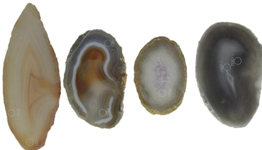
**Figura 116.** Amostras de lâminas de ágata com numeração 110, da categoria “vidrada” (110V1 e 110V2), seguida da categoria “bandada” (110B1 e 110B2), “sal” (110S1e 110S2) e “massa” (110M1 e 110M2), da esquerda para a direita. Amostras submetidas ao tingimento em rosa orgânico, para a concentração 5, antes do tingimento.
