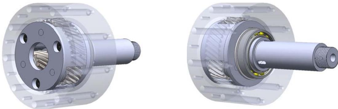
Figura 5.12 - Vista general de la segunda etapa de transmisión reductora
