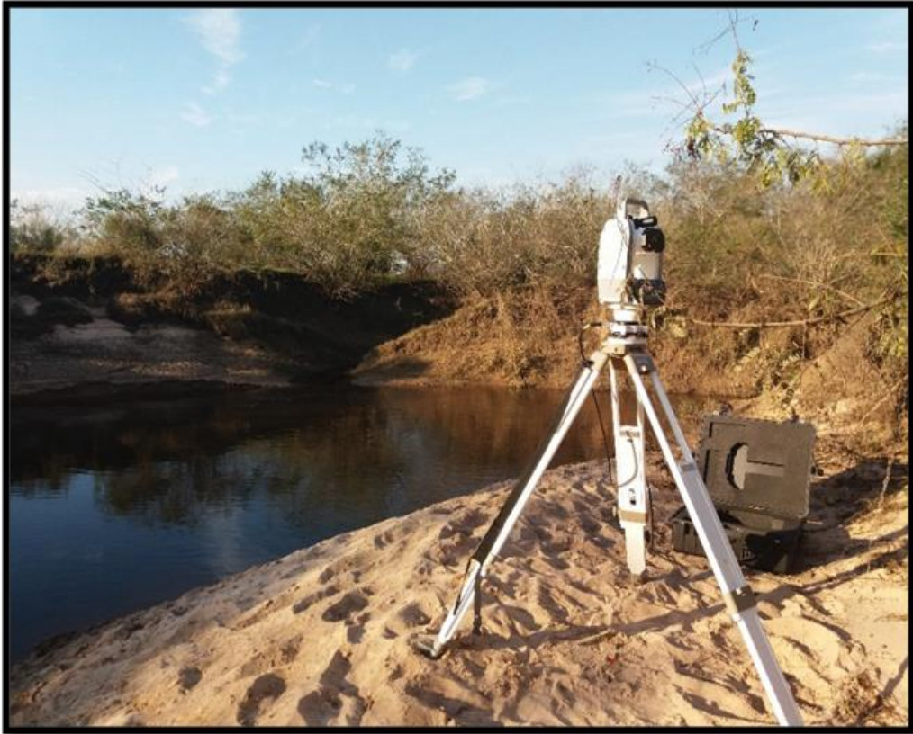
Figura 4.3. LST modelo Renishaw (MDL) Quarryman® Pro LR 3D montado no tripé realizando a varredura na área da voçoroca. Fotografado por: ETCHELAR, C. B em saída de campo do dia 28/06/2017.
